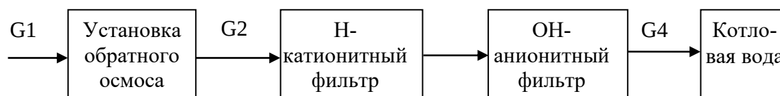
Рисунок 11 – Материальный баланс ионообменной очистки
