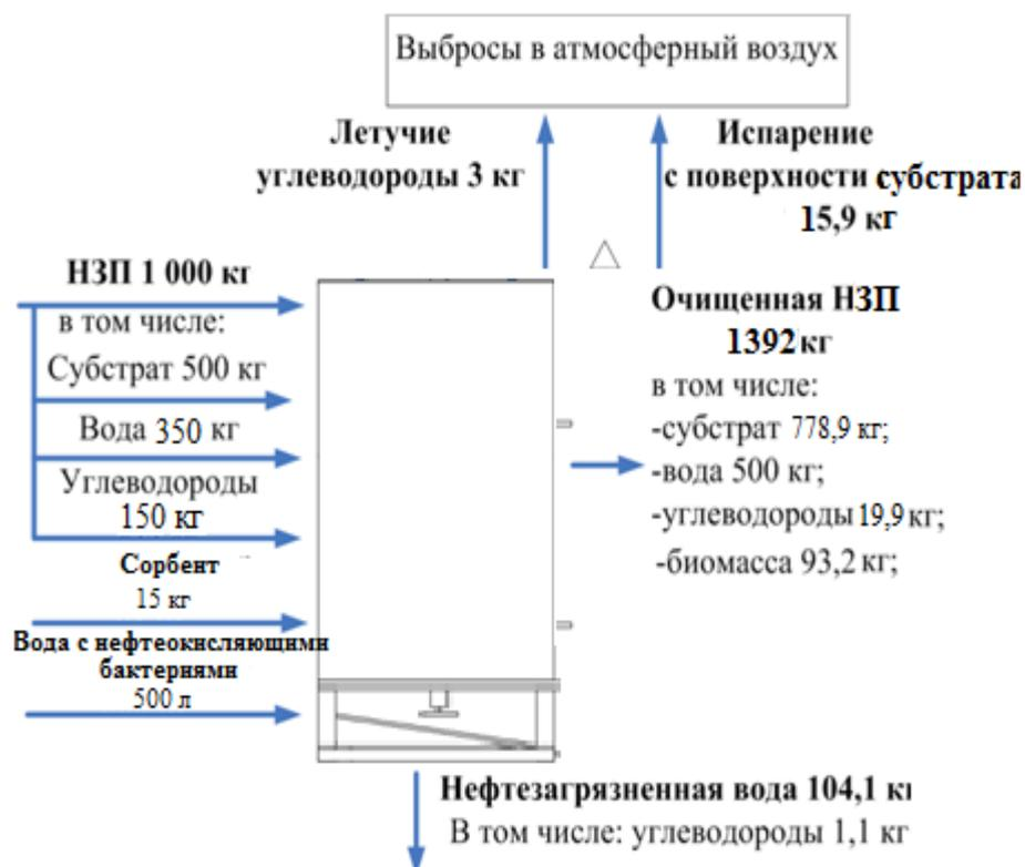
Рисунок 17 – Балансовая схема протекания процесса биоремедиации в мобильном комплексе
