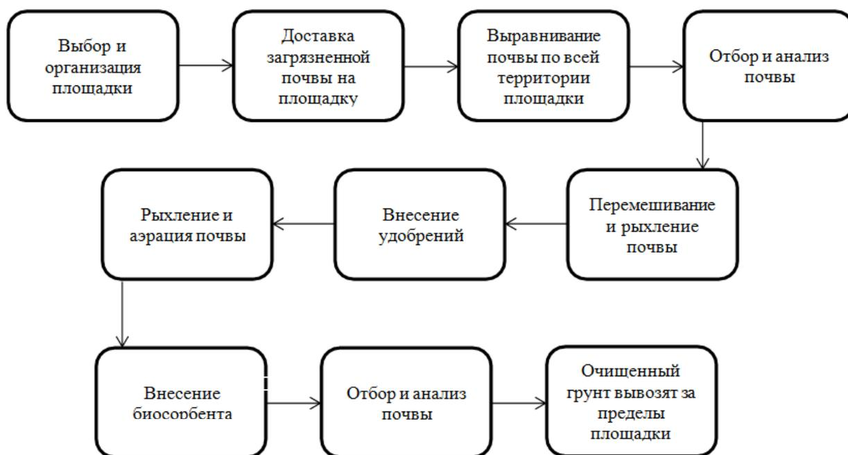
Рисунок 7 - Технологическая схема протекания процесса биоремедиации *ex situ*
