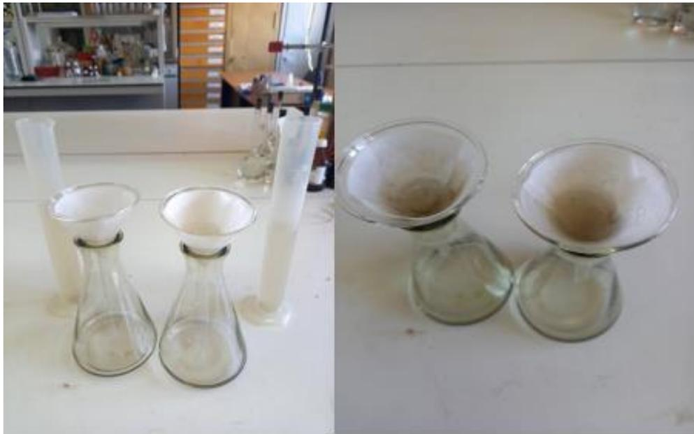
Рисунок 7 – Пробы воды после аэрируемых песколовков
