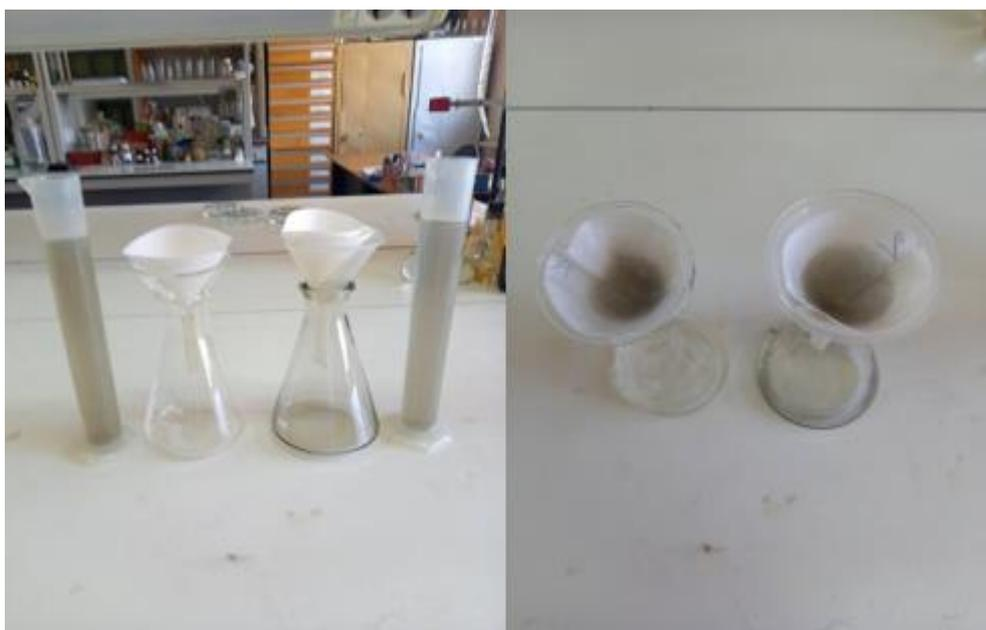
Рисунок 6 – Пробы воды до аэрируемых песколовков
