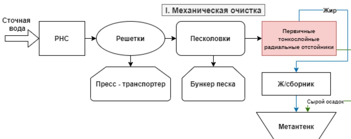
Рисунок 12 – Предлагаемая технологическая схема очистки сточных вод
