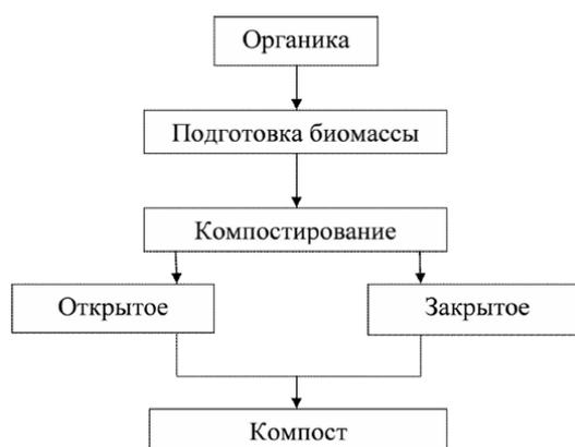
Рисунок 2 – Принципиальная схема переработки органических отходов в КОМПОСТ
