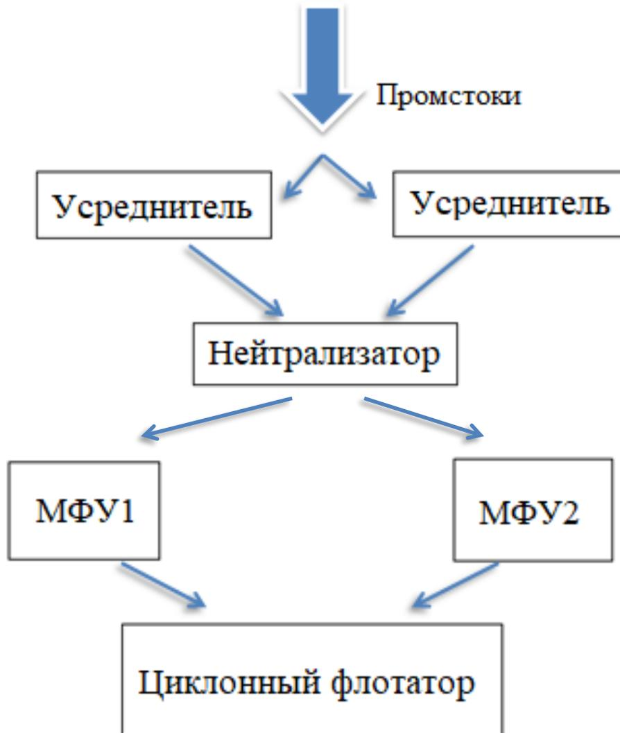
Рисунок 6- Предлагаемая блок схема очистки стоков, включающая в себя циклонный флотатор [18]
