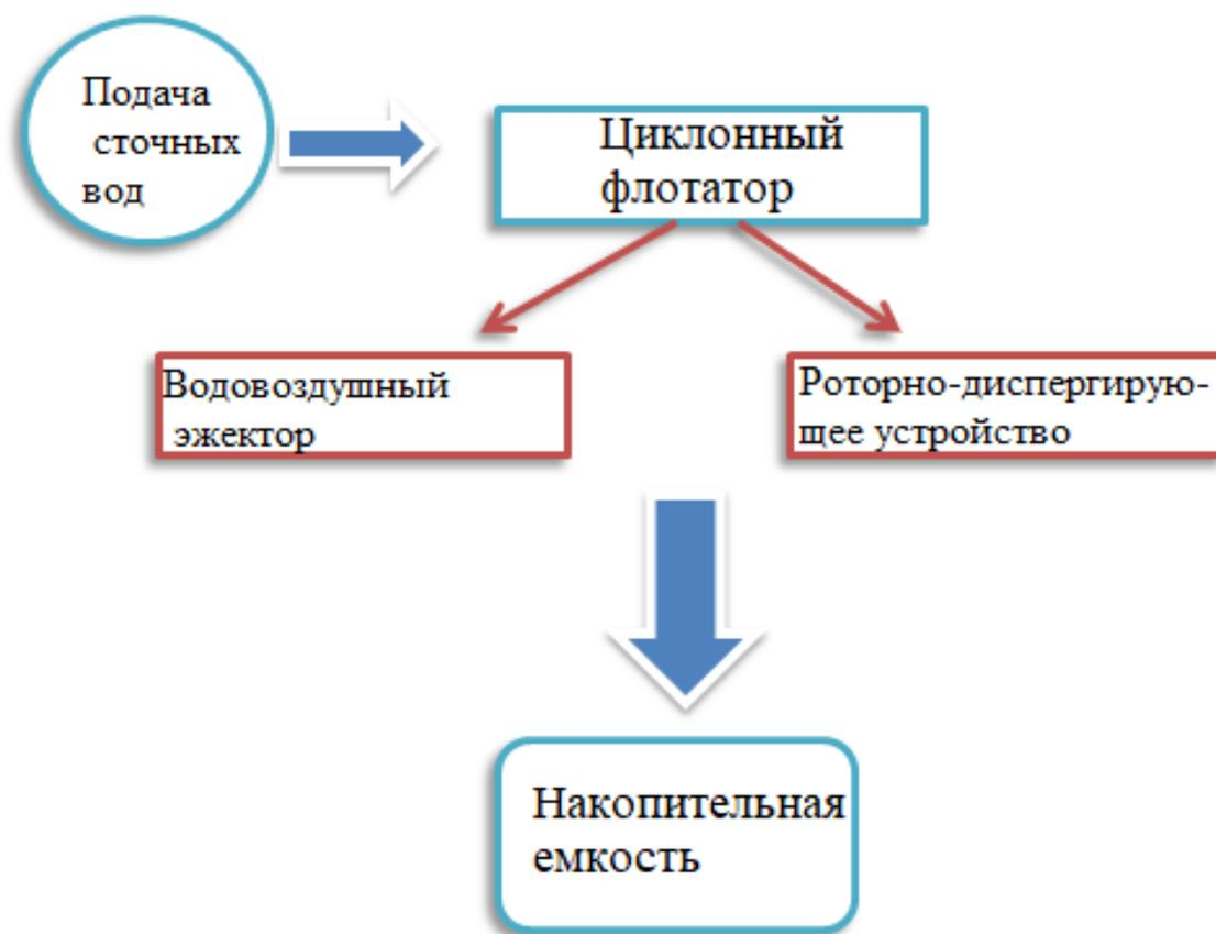
Рисунок 5 - Схема технологии работы циклонного флотатора [13]
