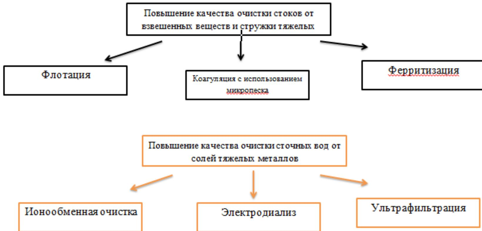
Рисунок 2 - Схема предлагаемых технологических решений [8]
