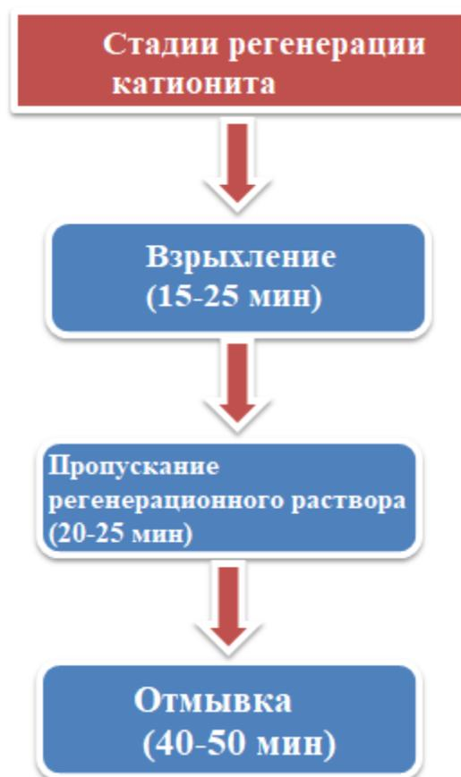
Рисунок 12- Стадии регенерации катионита [19]
