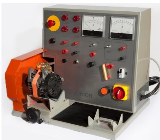
Рисунок 1.2 – Стенд для проверки генераторов и стартеров EB380
