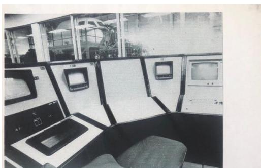
Полноразмерный стенд отработки бортового оборудования МКС «Буран». Пультый комплекс управления испытаниями (фрагмент)
