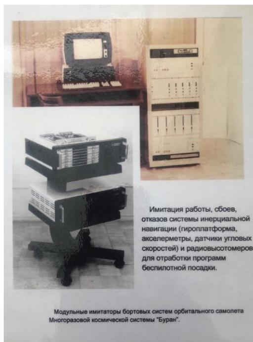
Рисунок 8 – «Модульные имитаторы бортовых систем орбитального самолета МКС «Буран»»
