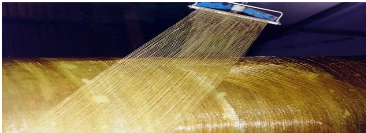
Рисунок 14 – Для изготовления труб используют разные способы навивки и намотки материала
