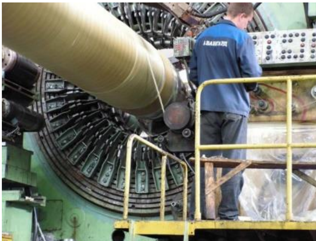
Рисунок 23 – Изготовление стеклопластиковых труб методом продольно-поперечной намотки
