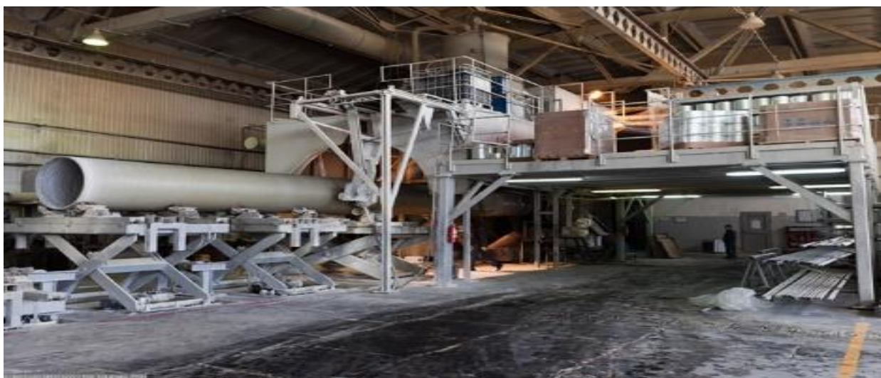
Рисунок 19 – Изготовление стеклопластиковых труб методом экструзии
