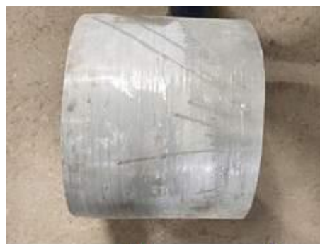
Рисунок 42 – Подтёки связующего на наружной поверхности
