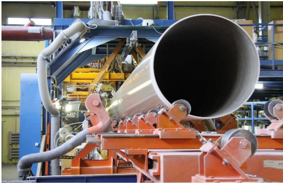
Рисунок 12 – Производство стеклопластиковых труб
