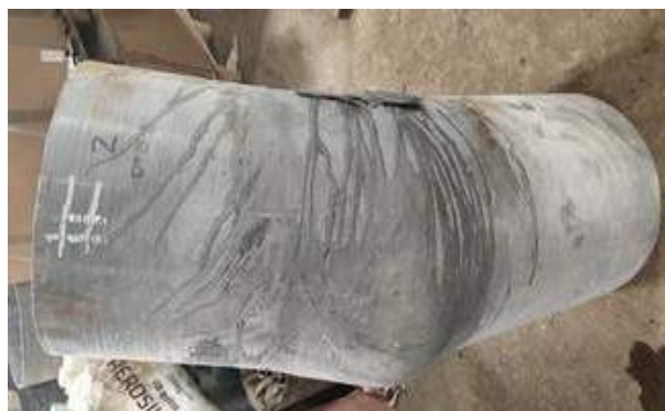
Рисунок 38 – Отслоение наружного слоя
