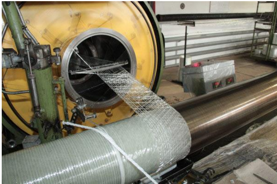
Рисунок 24 – Изготовление стеклопластиковых труб методом продольно-поперечной косослойной намотки
