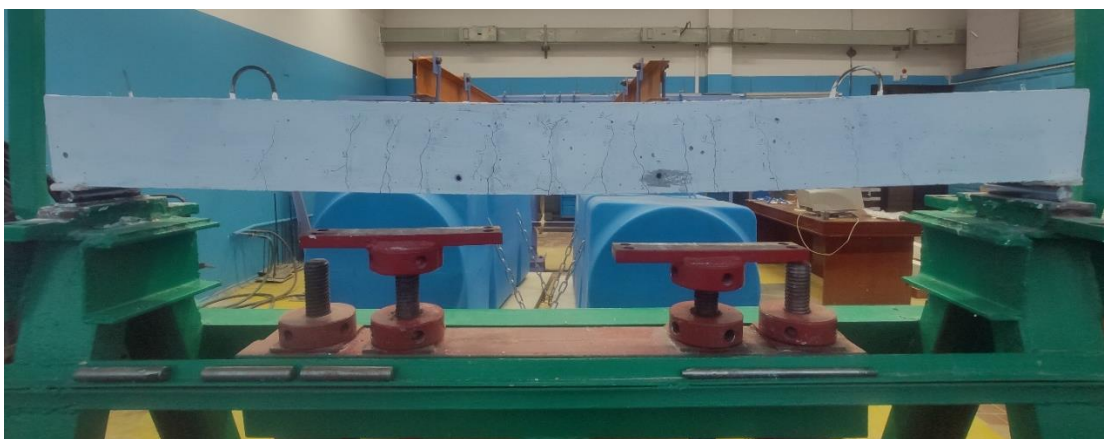
Рисунок 17 – Внешний вид балки после разрушения
