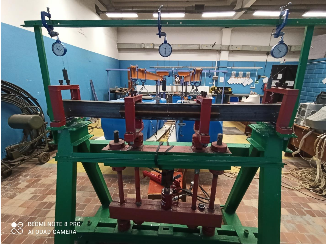
Рисунок 55 - Вид усиленной балки Б5 после испытания
