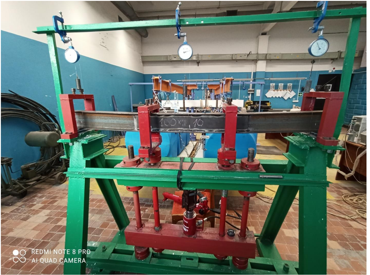
Рисунок 51 - Вид усиленной балки Б4 после испытания
