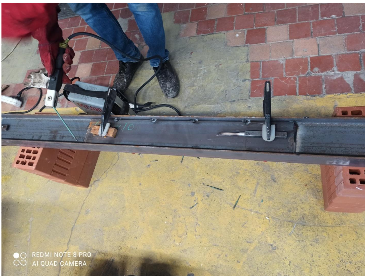
Рисунок 48– Прикрепление двух полос - 100х10 с двух сторон стенки симметрично образца балки Б4
