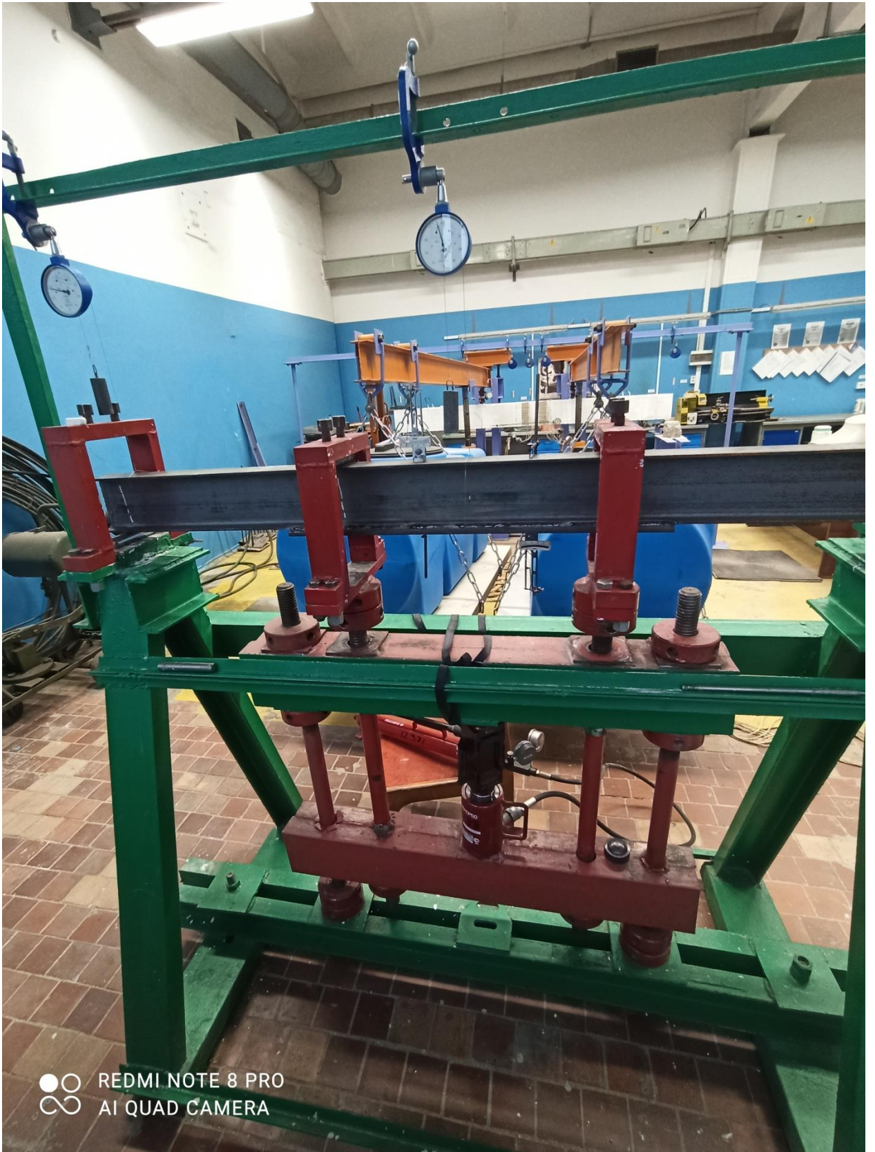
Рисунок 43 - Вид усиленной балки Б2 после испытания
