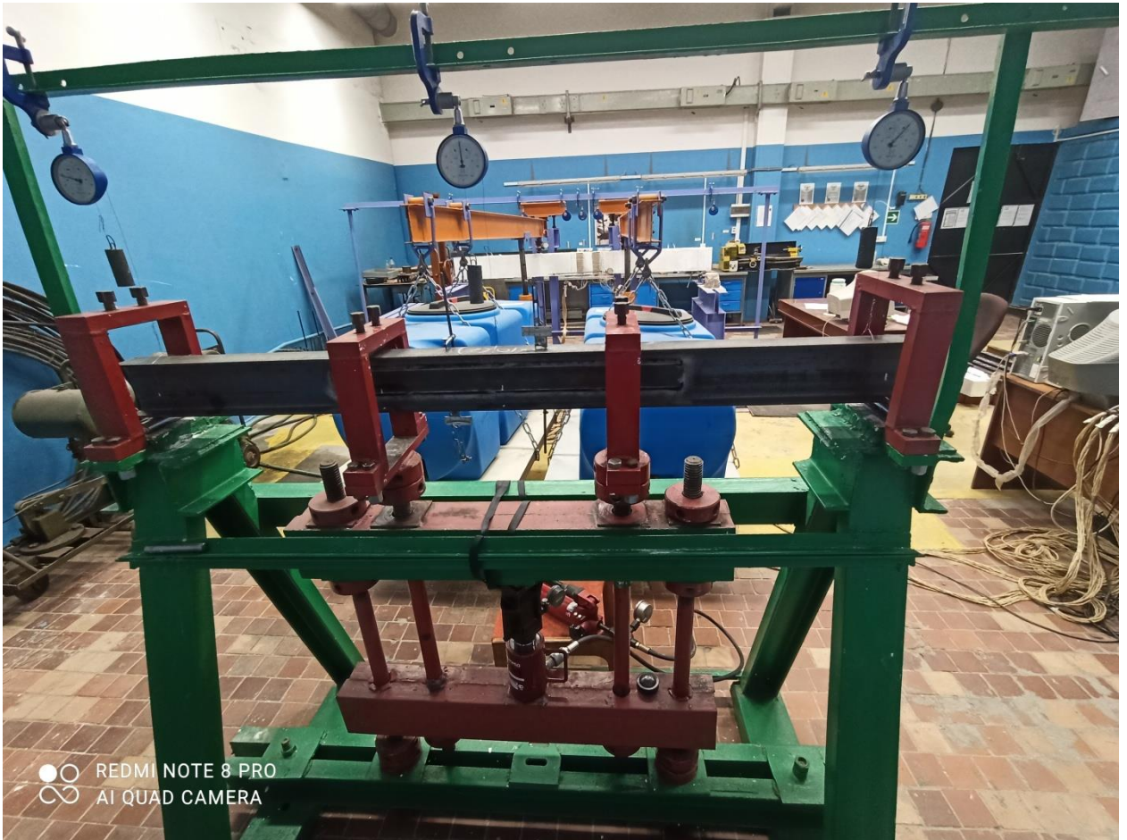
Рисунок 45– Испытание образца Б3, усиленного двумя полосами - 50x10 симметрично с двух сторон
