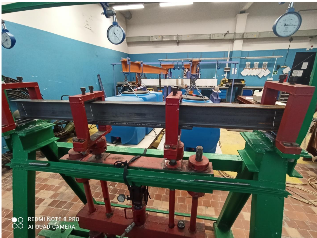
Рисунок 41– Испытание образца усиленного полосой в нижней части- 100x10
