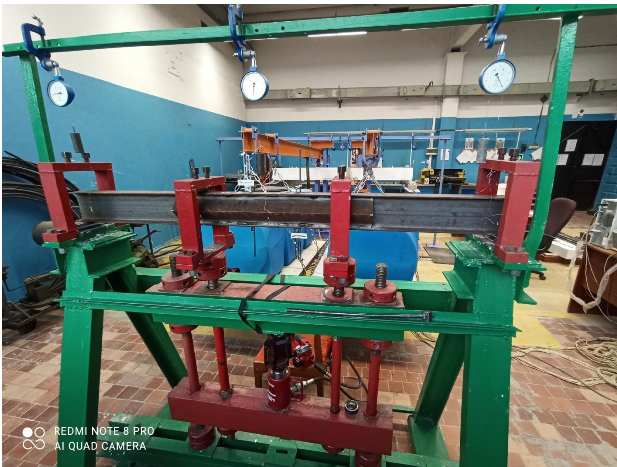
Рисунок 53– Испытание образца Б5, усиленного двумя уголками L75x6 симметрично с двух сторон
