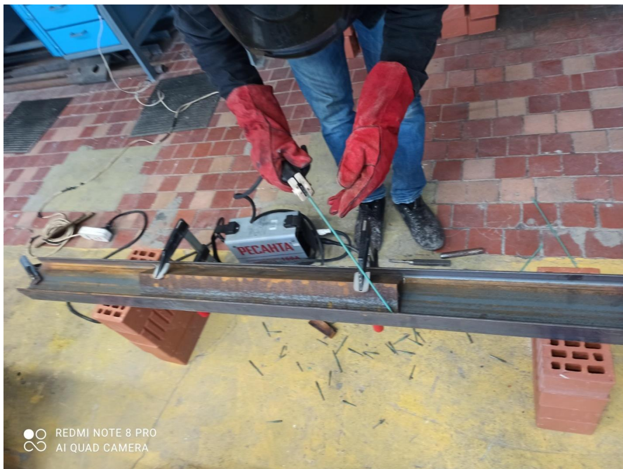
Рисунок 52– Прикрепление уголков L75x6 с двух сторон стенки симметрично образца балки Б5
