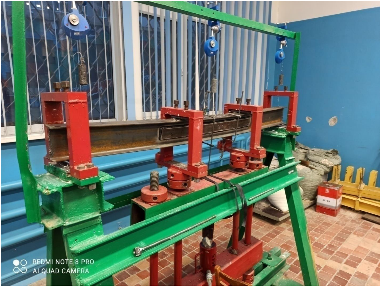
Рисунок 47 - Вид усиленной балки Б3 после испытания
