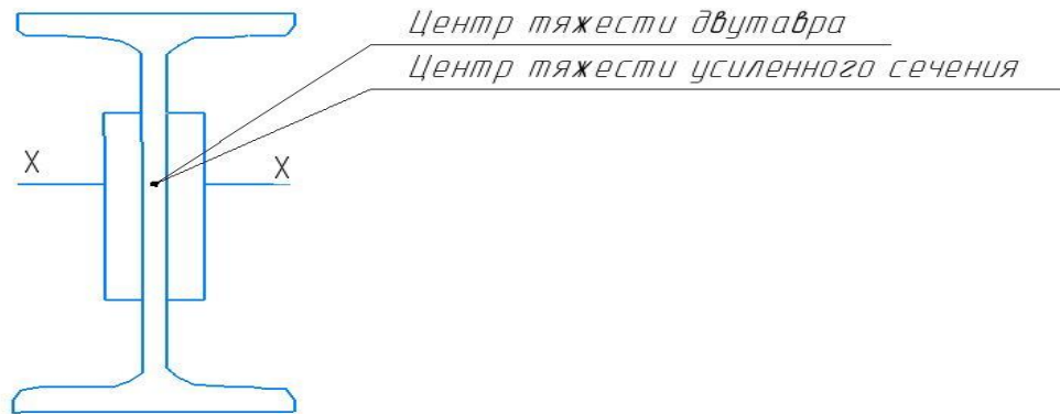
Рисунок 28 – Усиление двумя полосами 100x10
