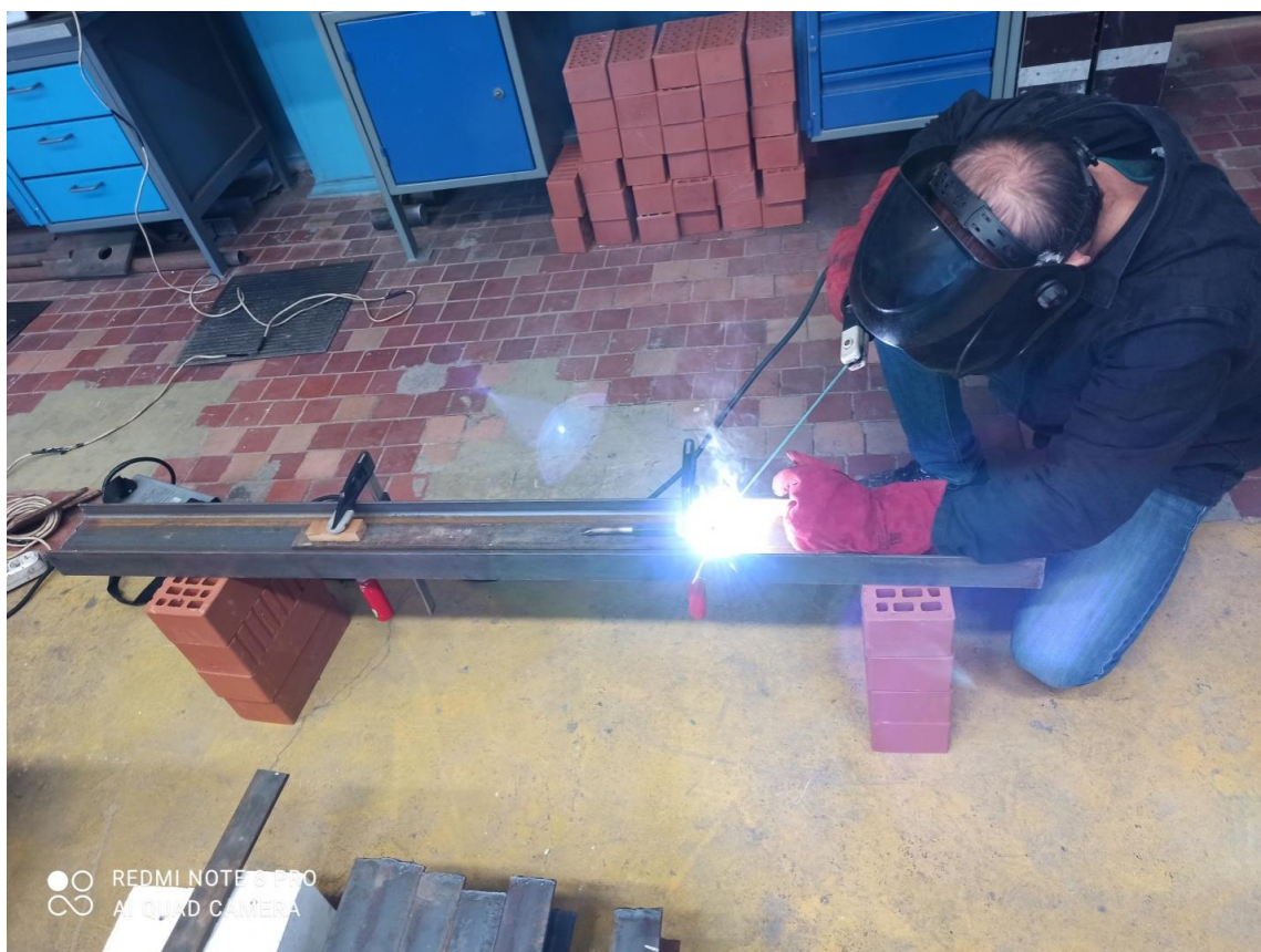
Рисунок 44– Прикрепление двух полос - 50x10 с двух сторон стенки симметрично образца балки БЗ
