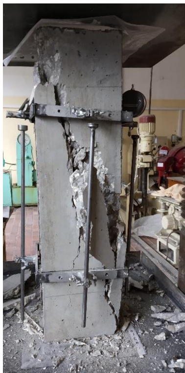
Рисунок 11 – Разрушенный после испытаний образец
