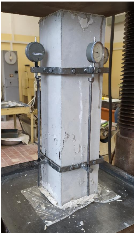
Рисунок 12 – Разрушение образца П30.75.2
