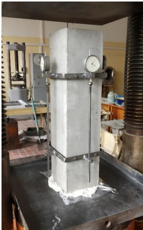
Рисунок 9 – Образец, подготовленный для проведения испытаний
