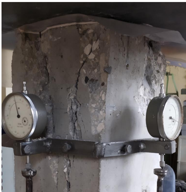
Рисунок 10 – Трещины у опорных граней образца
