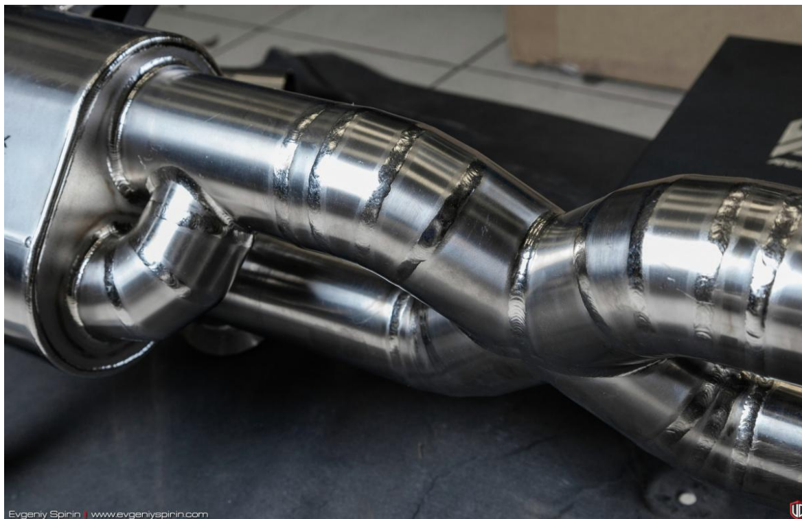
Рисунок 9 – Доработка трассы выпуска отработавших газов
