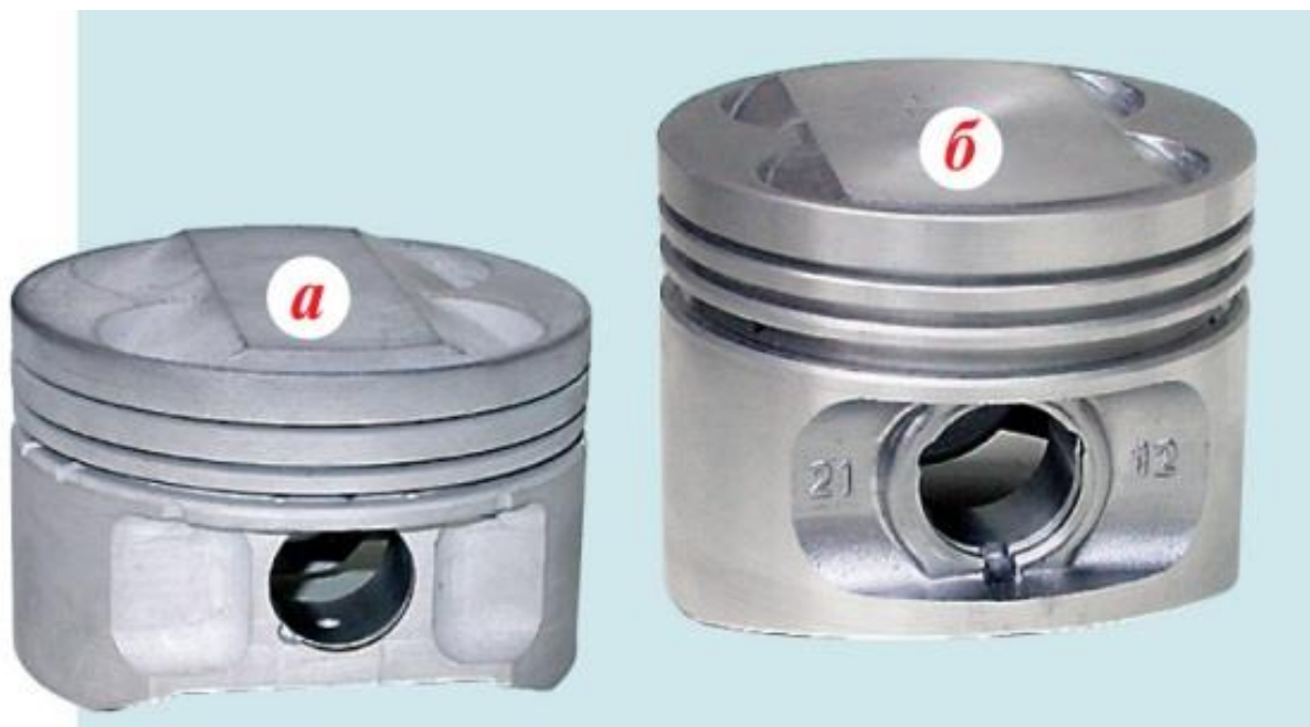
Рисунок 4 – Уменьшение веса поршня: облегченный (а) и серийный (б) поршни
