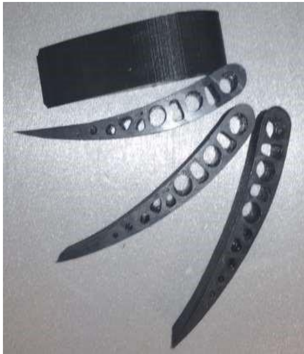
Рисунок 33 – Шпангоуты, напечатанные на 3D-принтере
