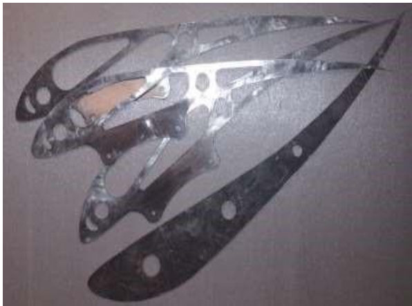
Рисунок 31 – Шпангоуты из алюминия, толщиной 2 мм
