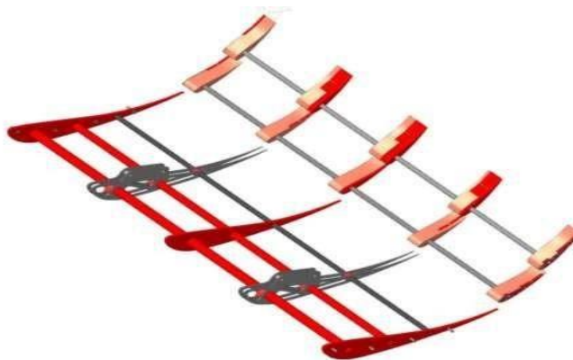
Рисунок 29 – 3D-модель пространственной рамы для заднего антикрыла
