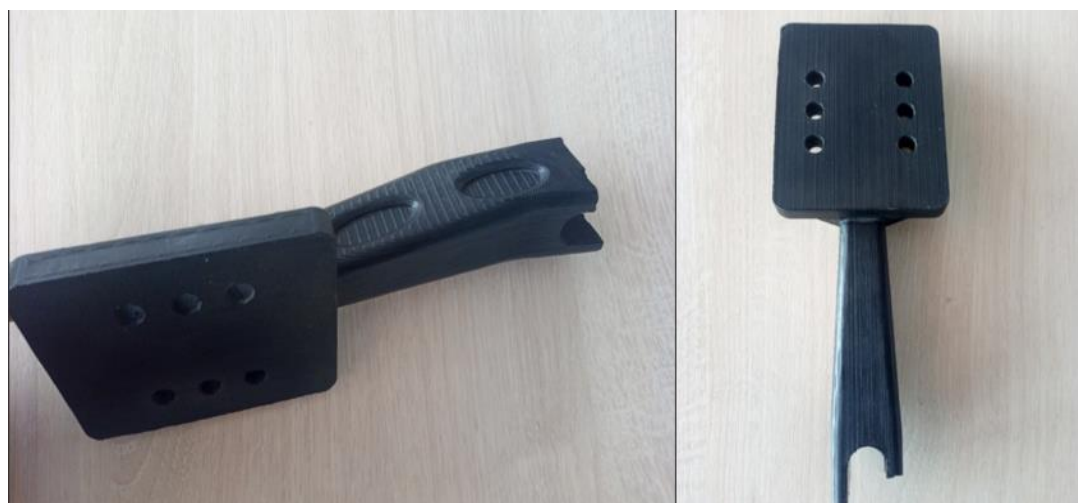
Рисунок 50 – Педаль сцепления, напечатанная на 3D-принтере из АБС-пластика
