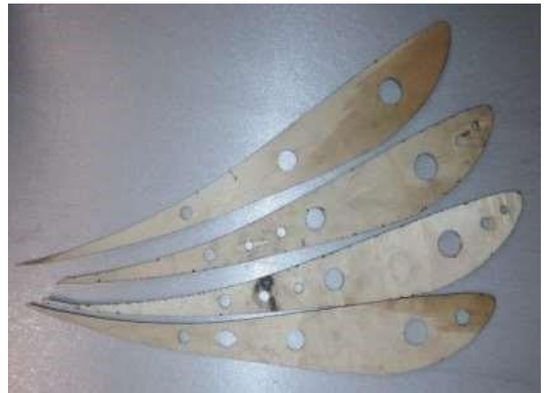
Рисунок 32 – Шпангоуты из фанеры, толщиной 6 мм
