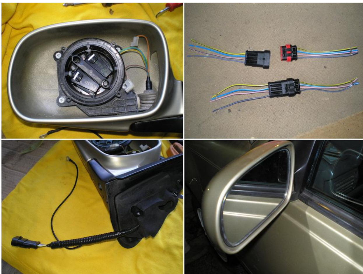
Рисунок 16 – Монтаж зеркала с электроприводом
