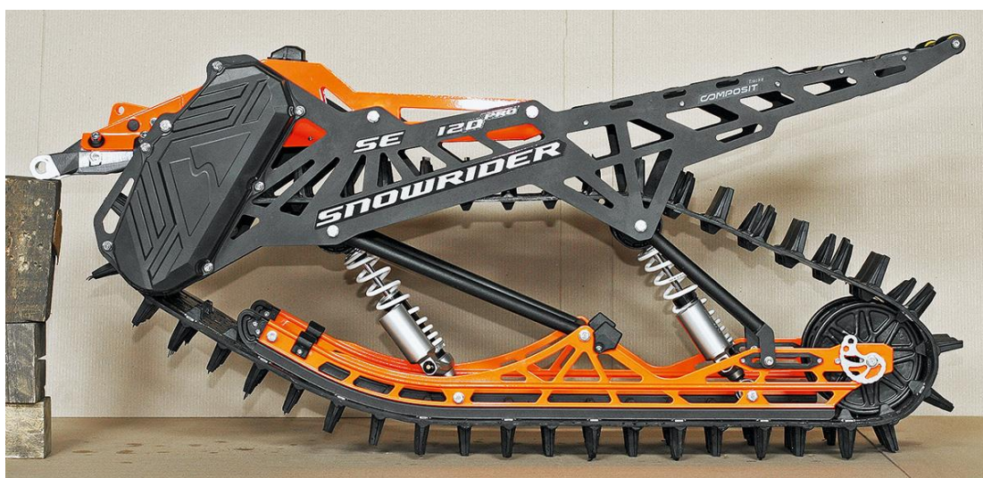
Рисунок 18 – Набор для установки гусеничного комплекта
