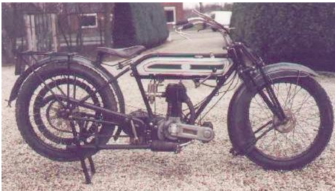
Рисунок 3 – Triumph SD, 1-цил. SV 500cc, 1921-1927 гг.
