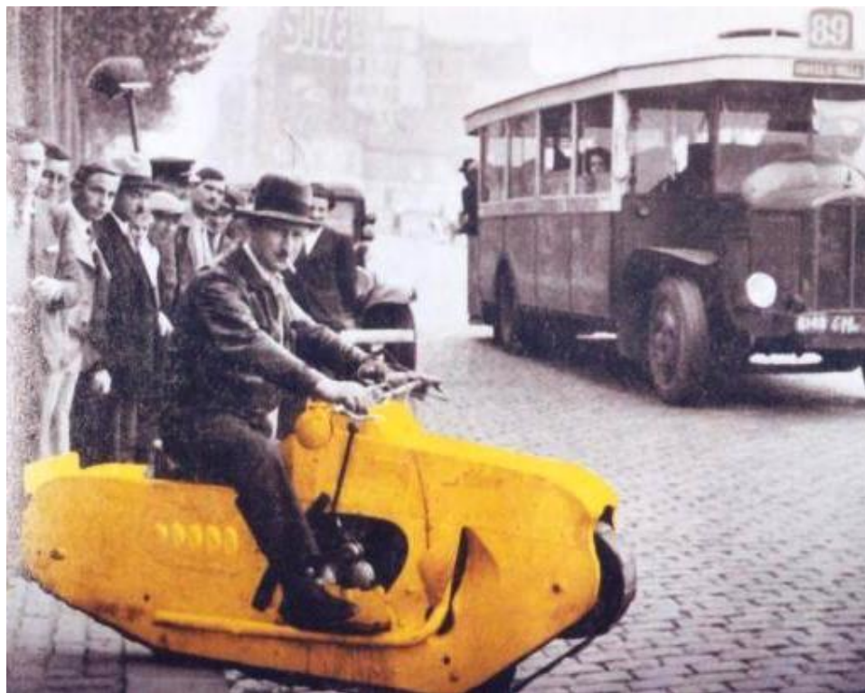
Рисунок 11 – Мотоцикл Мерсье Motochenilles Тип 3, с бронещитом на испытаниях, 1937 г.
