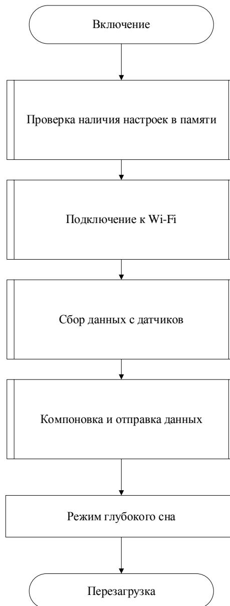
Рисунок 20 - Алгоритм работы программы (общий вид)
