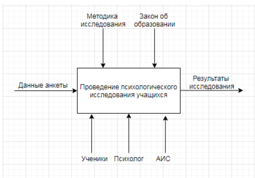
Рисунок 3 – Контекстная диаграмма IDEF0 (A-0) «КАК ДОЛЖНО БЫТЬ» бизнес-процесса «Проведение психологического исследования учащихся»
