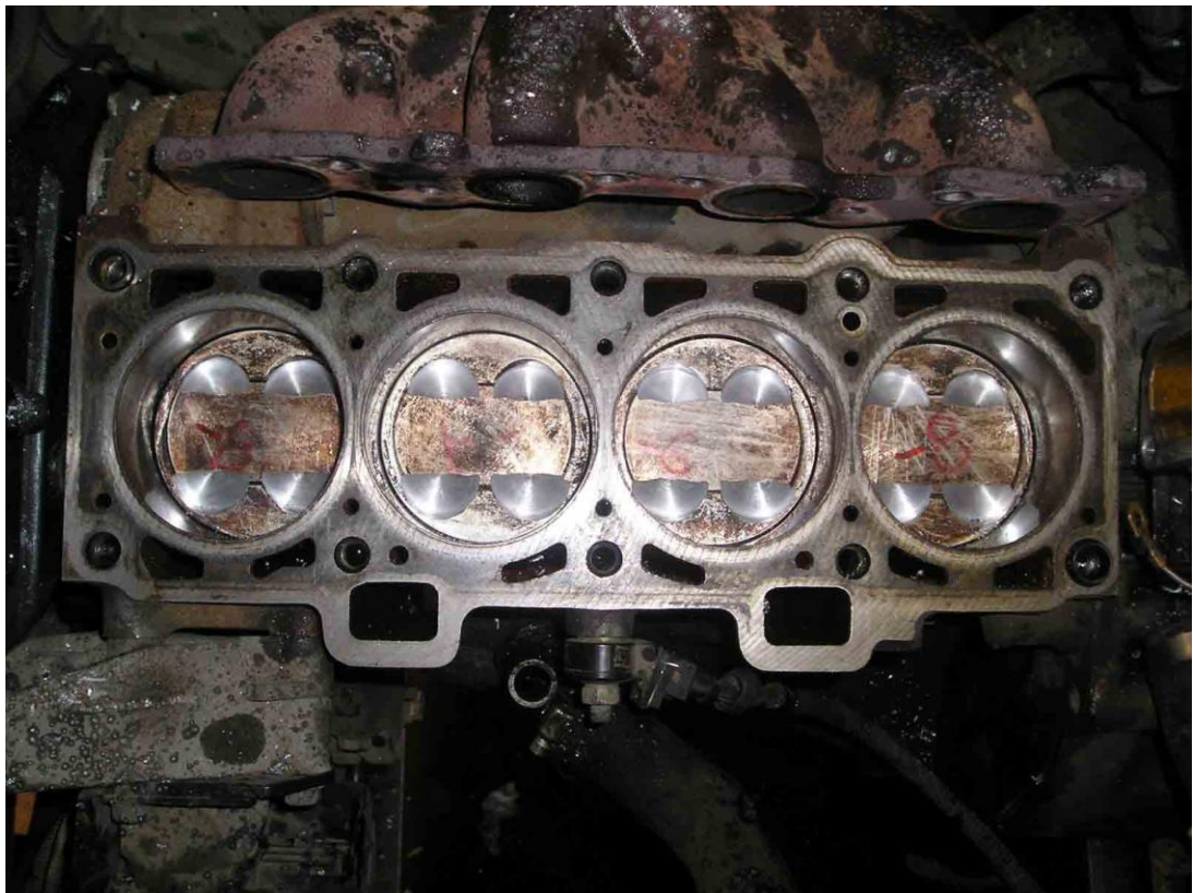
Рисунок 2.3. Процесс доработки поршней с использованием кондуктора без демонтажа поршней.
