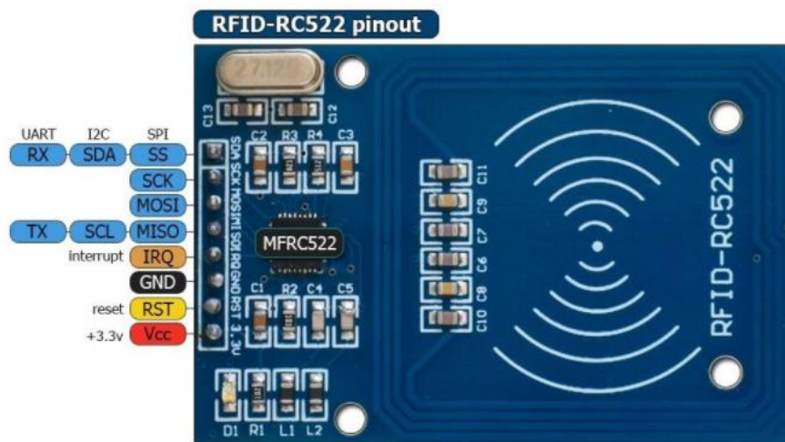
Рисунок 19 – Выводы RFID модуля RC522
