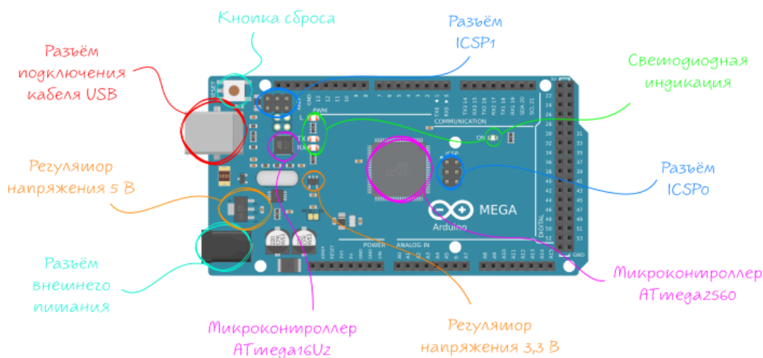
Рисунок 9 – Структура Arduino Mega 2560
