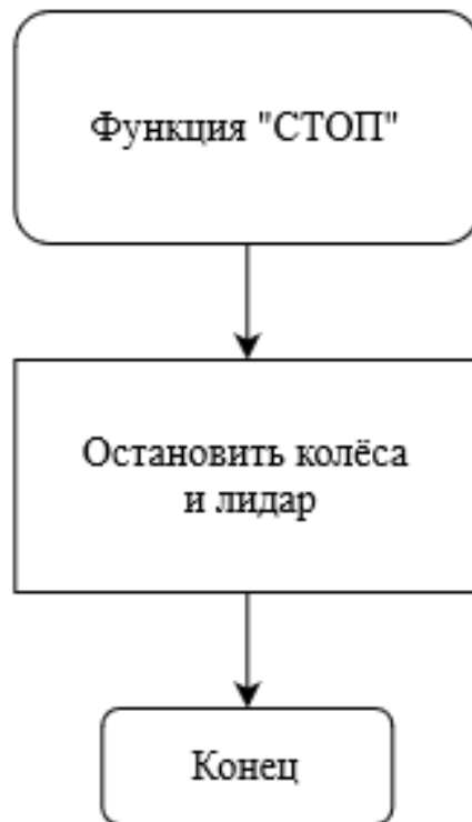
Рисунок 32 – Блок-схема функции «СТОП»
