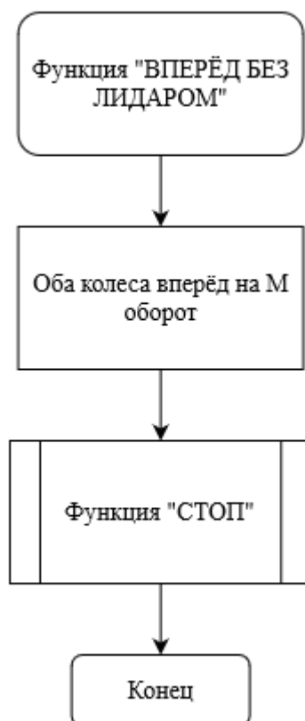
Рисунок 29 – Блок-схема функции «ВПЕРЁД БЕЗ ЛИДАРА»
