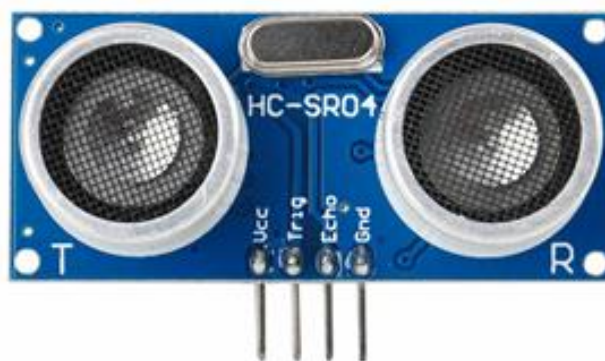
Рисунок 11 – Ультразвуковой датчик расстояния HC-SR04
