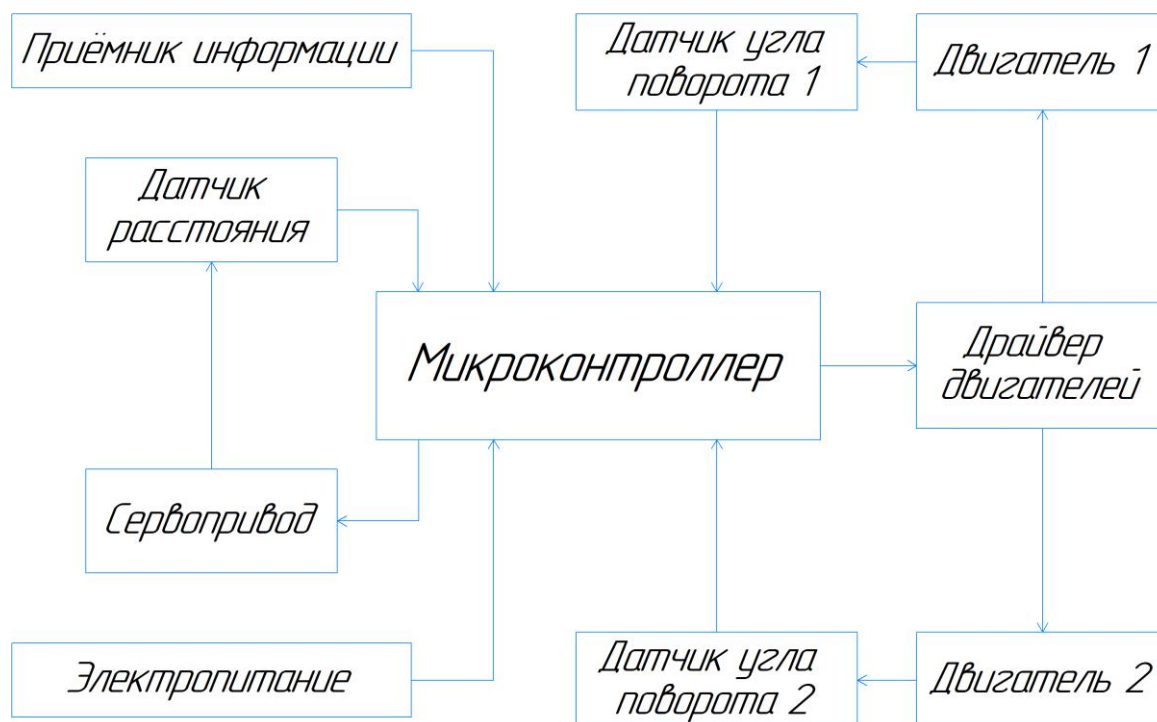
Рисунок 6 – Структурная схема беспилотного мобильного робота
