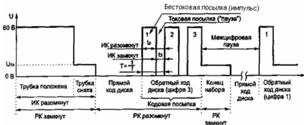
Рисунок 3 - Временные диаграммы напряжений на линейных зажимах ТА с дисковым НН при наборе номера 31
