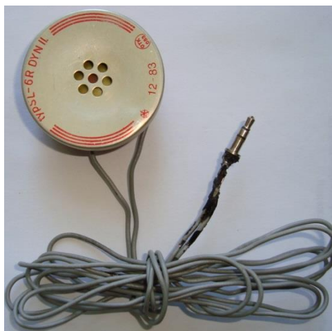
Рисунок 3.7 – Динамик для прослушивания телефонного разговора
