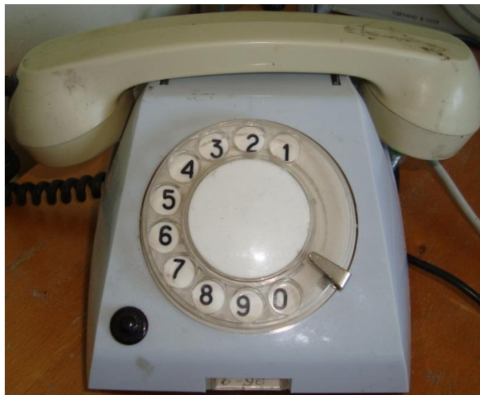
Рисунок 3.4 – Аналоговый телефонный аппарат
