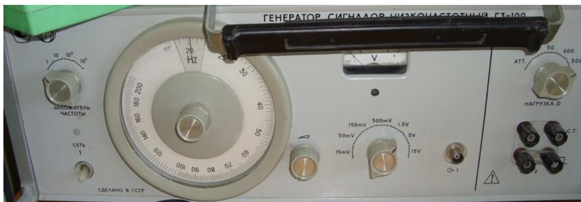
Рисунок 3.2 – Генератор сигналов для лабораторного стенда
