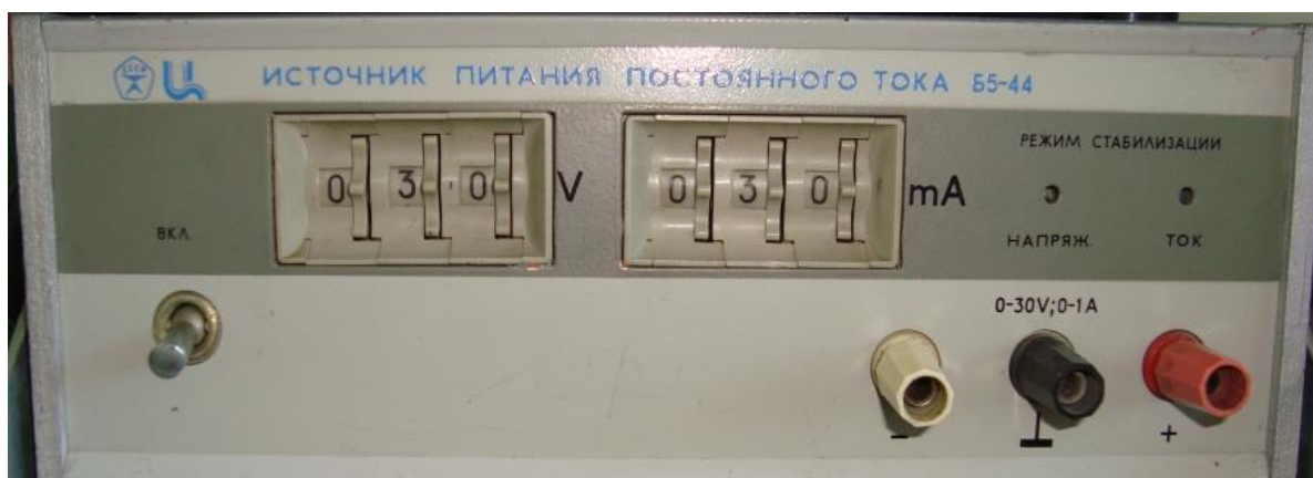
Рисунок 3.1 – Источник питания для лабораторного стенда
