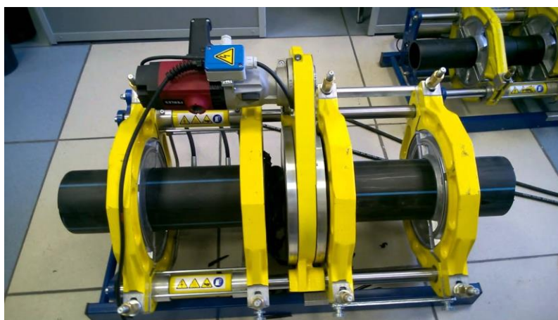
Рисунок 7 – Установка для сварки нагретым инструментом труб
