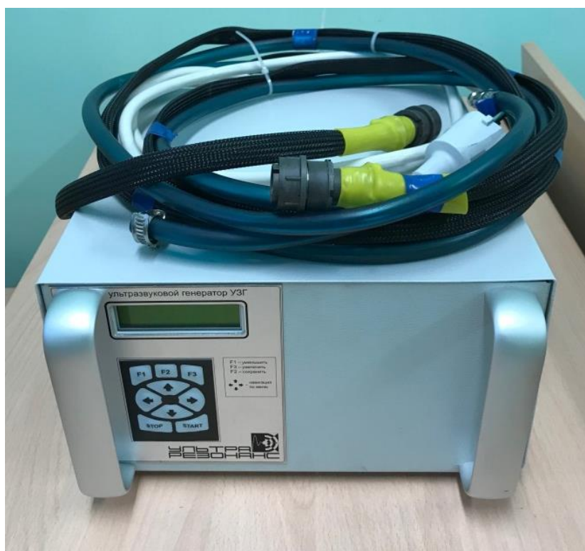
Рисунок 35 – Ультразвуковой генератор УЗГ-22-1-М Ультразвуковую колебательную систему (рисунок 36):
