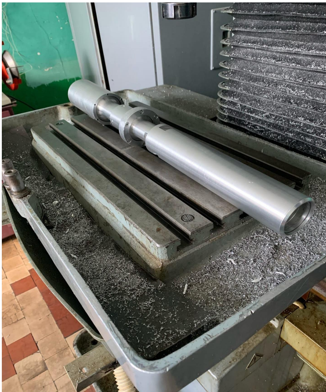
Рисунок 33 – Ультразвуковая колебательная система для сварки корпуса клапана адсорбера
