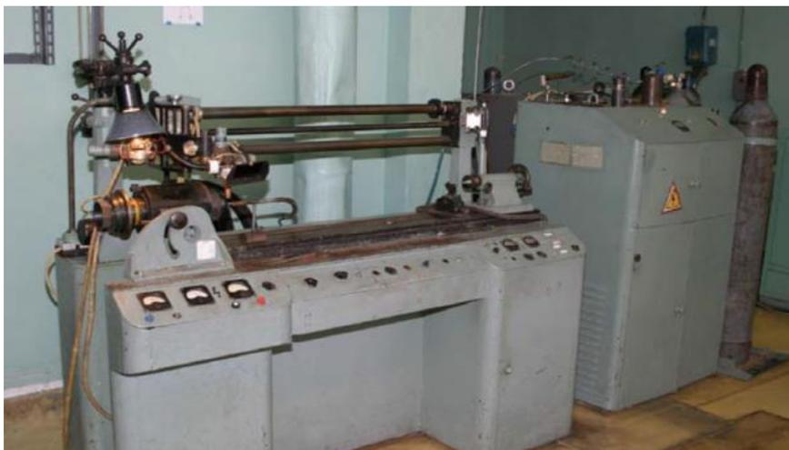
Рисунок 14 - Установка сварки кольцевых швов
