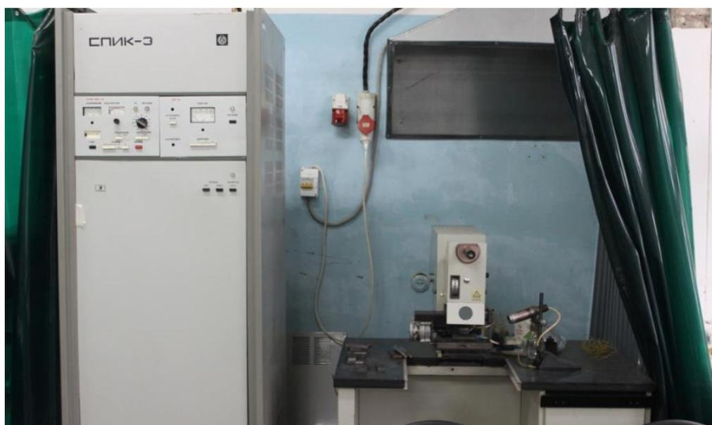
Рисунок 5 - Установка импульсной лазерной сварки КВАНТ-15
