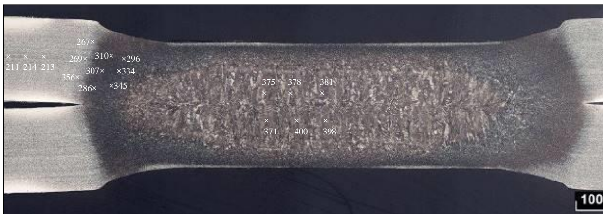
Рисунок 3.71 – Схема замеров твердости HV1 сварной точки 6.1.1
