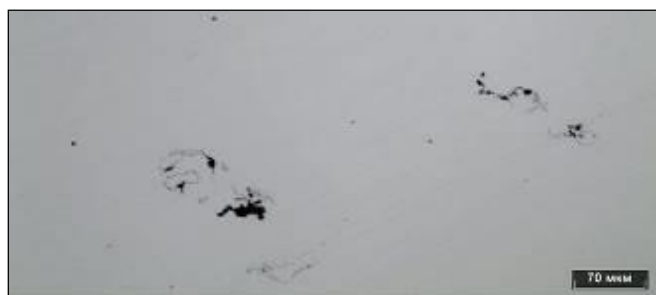
Рисунок 3.109 – Дефект в литом ядре в сварной точке 10.1.2, не травлено
