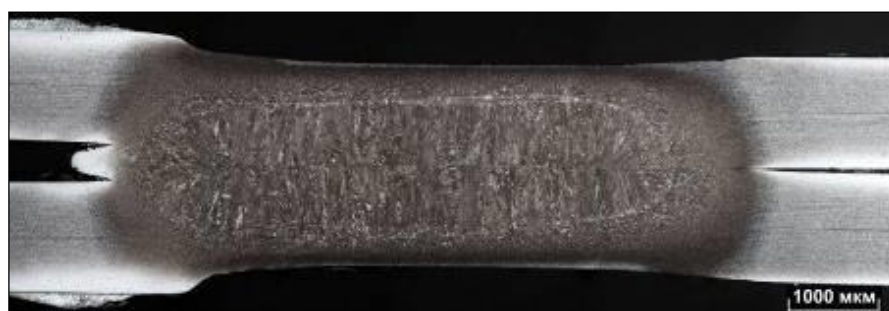
Рисунок 3.87 – Макроструктура сварной точки 8.1.1
