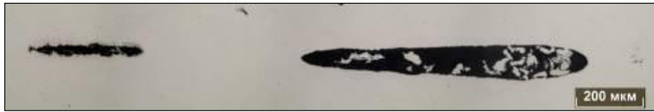
Рисунок 3.20 – Дефекты в литом ядре в сварной точке 1.1.3, не травлено
