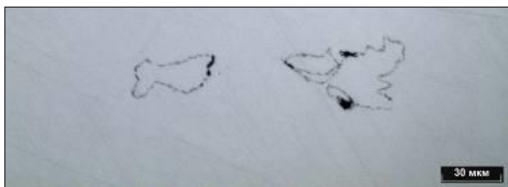
Рисунок 3.125 – Дефект в литом ядре в сварной точке 12.1.3, не травлено
