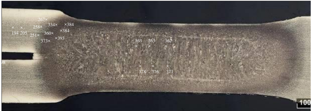
Рисунок 3.42 – Схема замеров твердости HV1 сварной точки 3.1.1
