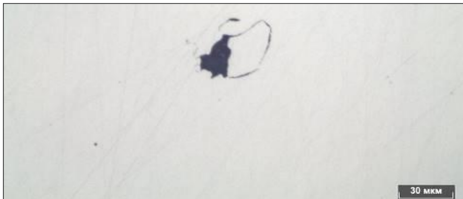
Рисунок 3.47 – Дефект в литом ядре в сварной точке 4.1.3, не травлено
