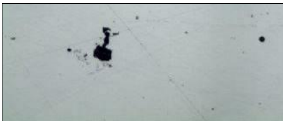
Рисунок 3.28 – Дефект в литом ядре в сварной точке 2.1.1, не травлено
