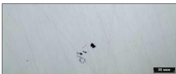
Рисунок 3.93 – Дефект в литом ядре в сварной точке 8.1.3, не травлено
