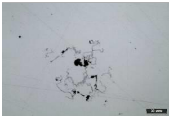
Рисунок 3.123 – Дефект в литом ядре в сварной точке 12.1.1, не травлено
