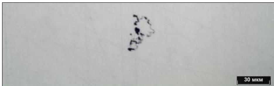
Рисунок 3.17 – Дефект в сварной точке 1.1.1, травитель – нитал
