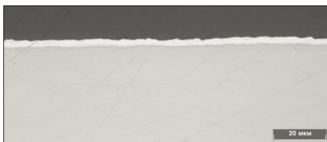
Рисунок 1.4 – Микроструктура поперечного сечения образца проката DP600+Z140 толщиной 1.2 мм
