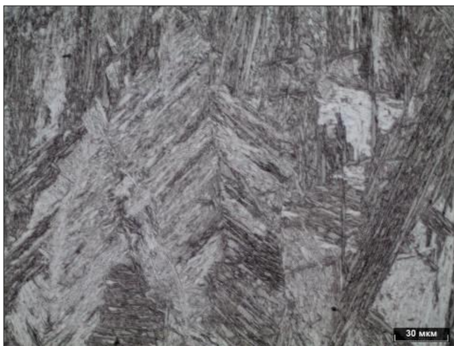
Рисунок 3.96 – Микроструктура зоны литого ядра точки 8.1.1, травитель – нитал
