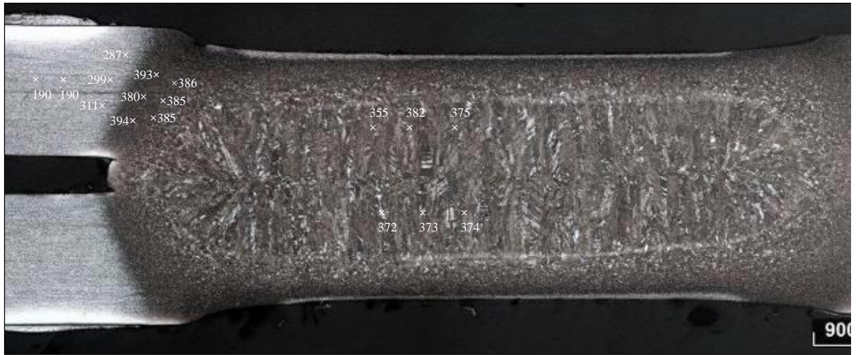
Рисунок 3.104 – Схема замеров твердости HV1 сварной точки 9.1.1
