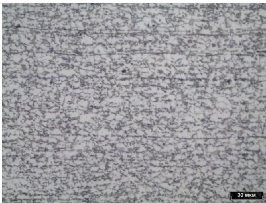
Рисунок 3.78 – Микроструктура проката вне зон сварки, точка 7.1.1, травитель – нитал
