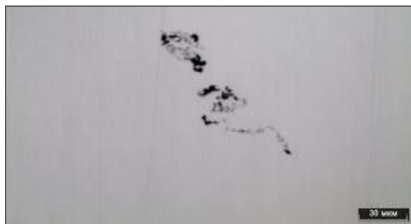
Рисунок 3.103 – Дефект в литом ядре в сварной точке 9.1.3, не травлено
