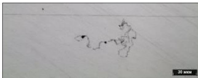
Рисунок 3.115 – Дефект в литом ядре в сварной точке 11.1.1, не травлено
