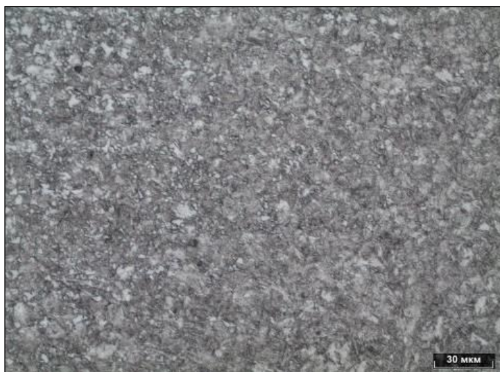
Рисунок 3.95 – Микроструктура ЗТВ точки 8.1.1, травитель – нитал
