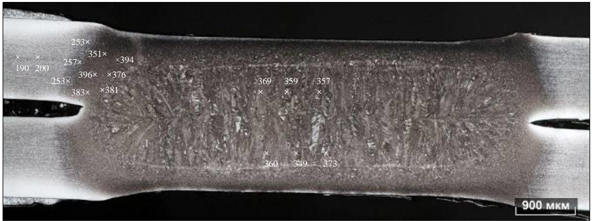
Рисунок 3.126 – Схема замеров твердости HV1 сварной точки 12.1.1
