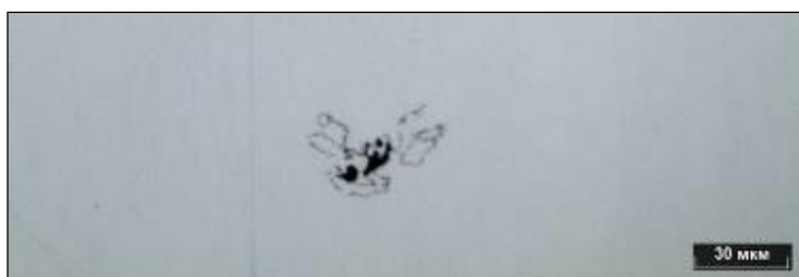
Рисунок 3.110 – Дефект в литом ядре в сварной точке 10.1.3, не травлено
