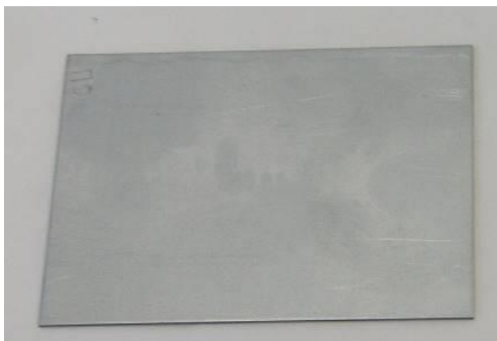
Рисунок 1.2 – Внешний вид образца проката марки DP600+Z140 толщиной 1.2 мм
