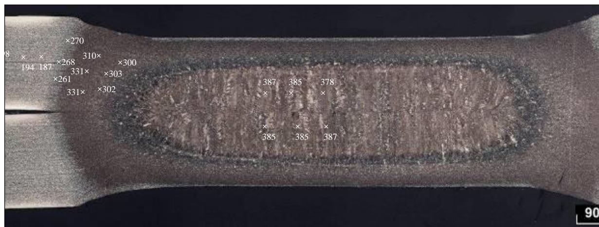
Рисунок 3.81 – Схема замеров твердости HV1 сварной точки 7.1.1
