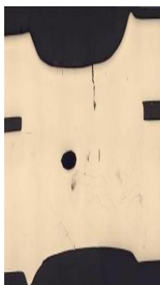
Рисунок 1.7 – Раковина, непровары и трещины с поверхности
