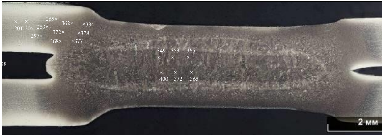
Рисунок 3.33 – Схема замеров твердости HV1 сварной точки 2.1.1
