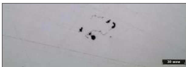
Рисунок 3.102 – Дефект в литом ядре в сварной точке 9.1.2, не травлено
