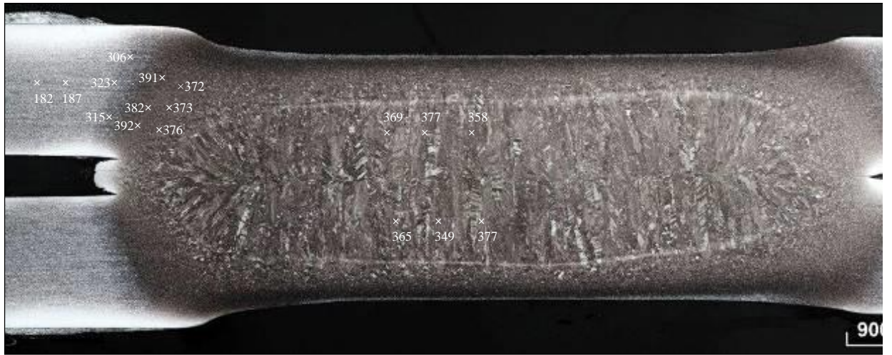
Рисунок 3.111 – Схема замеров твердости HV1 сварной точки 10.1.1
