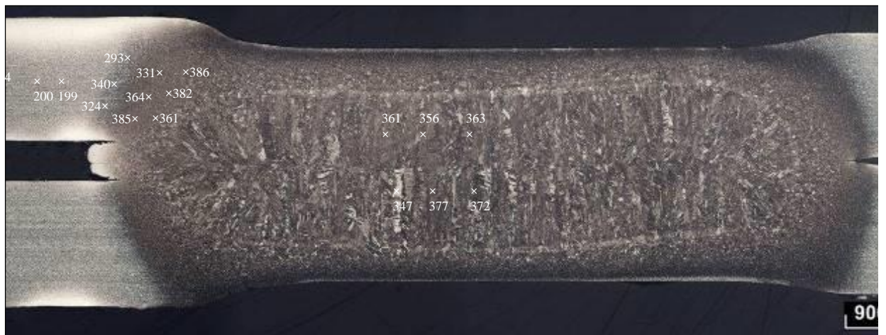
Рисунок 3.51 – Схема замеров твердости HV1 сварной точки 4.1.1
