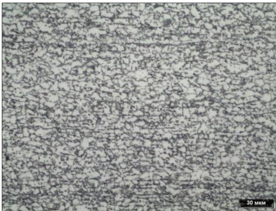
Рисунок 3.48 – Микроструктура проката вне зон сварки, точка 4.1.1, травитель – нитал
