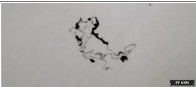
Рисунок 3.108 – Дефект в литом ядре в сварной точке 10.1.1, не травлено
