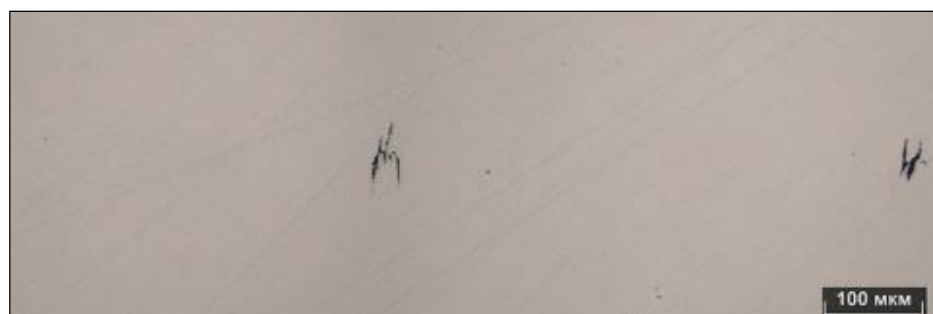
Рисунок 3.75 – Участок дефектов в литом ядре в сварной точке 7.1.1, не травлено
