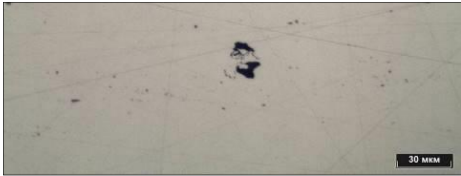
Рисунок 3.37 – Дефект в литом ядре в сварной точке 3.1.1, не травлено
