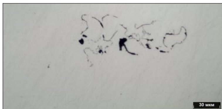
Рисунок 3.55 – Дефект в литом ядре в сварной точке 5.1.1, не травлено
