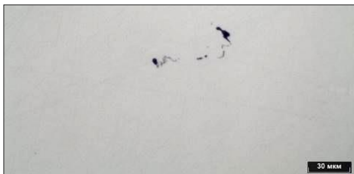
Рисунок 3.65 – Дефект в литом ядре в сварной точке 6.1.2, не травлено
