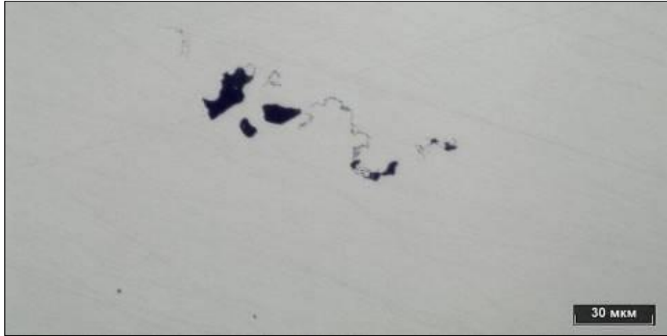
Рисунок 3.56 – Дефект в литом ядре в сварной точке 5.1.3, не травлено
