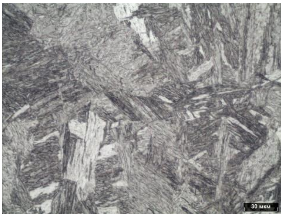
Рисунок 3.59 – Микроструктура зоны литого ядра точки 5.1.1, травитель – нитал
