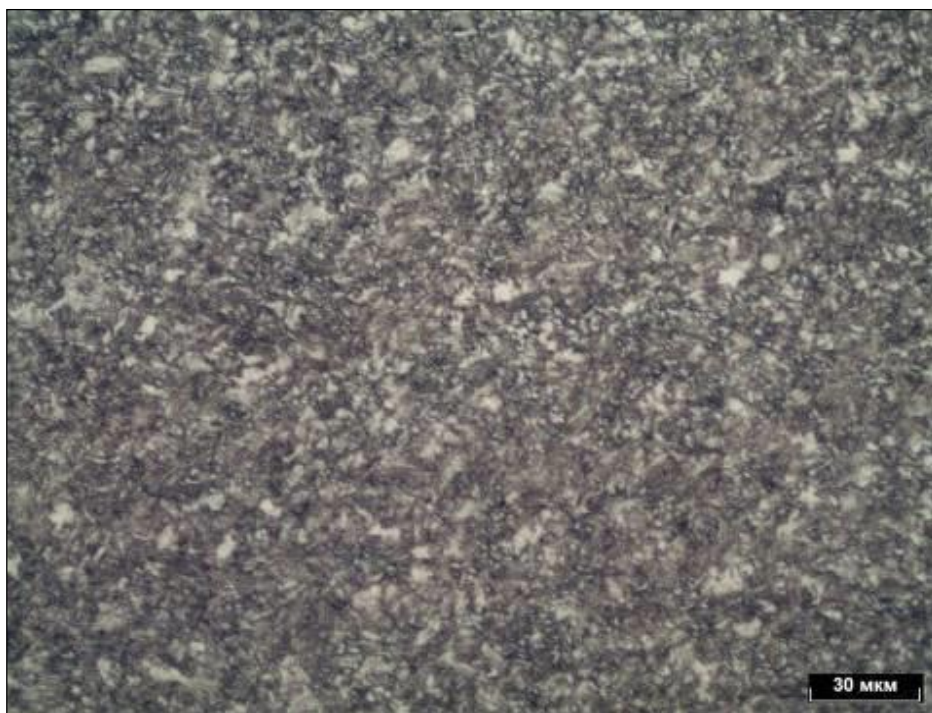
Рисунок 3.40 – Микроструктура ЗТВ точки 3.1.1, травитель – нитал
