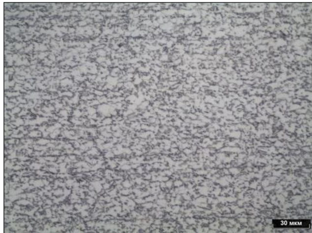
Рисунок 3.21– Микроструктура проката вне зон сварки, точка 1.1.1, травитель – нитал
