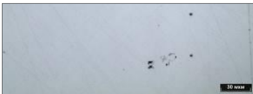
Рисунок 3.91 – Дефект в литом ядре в сварной точке 8.1.2, не травлено
