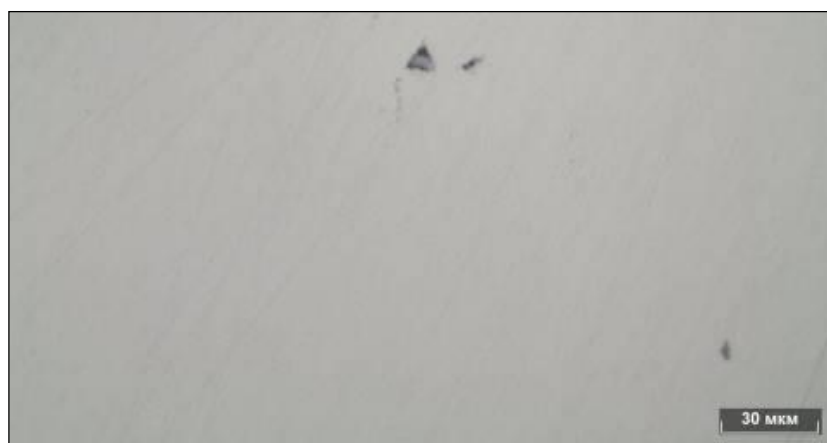
Рисунок 3.64 – Дефект в литом ядре в сварной точке 6.1.1, не травлено
