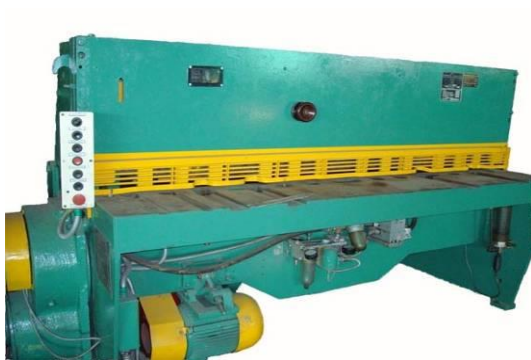
Рисунок 2.6 - Кривошипные листовые ножницы (гильотинные) с наклонным ножом НК3418
