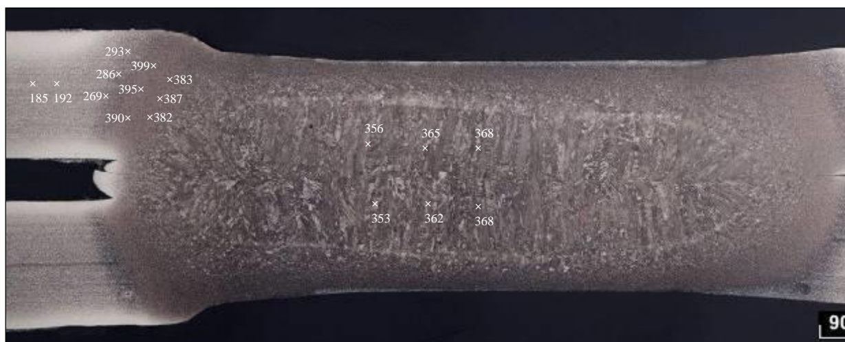
Рисунок 3.24 – Схема замеров твердости HV1 сварной точки 1.1.1
