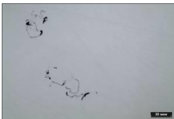
Рисунок 3.124 – Дефект в литом ядре в сварной точке 12.1.2, не травлено
