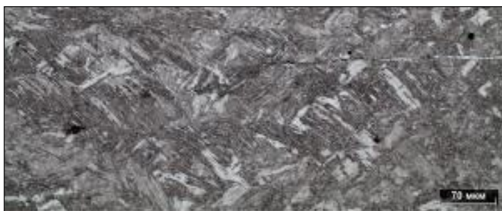
Рисунок 3.92 – Несплавление в сварной точке 8.1.2, не травлено
