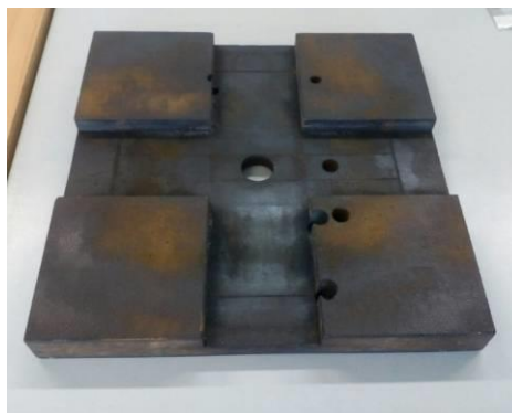
Рисунок 2.4 – Кондуктор для позиционирования сварных образцов
