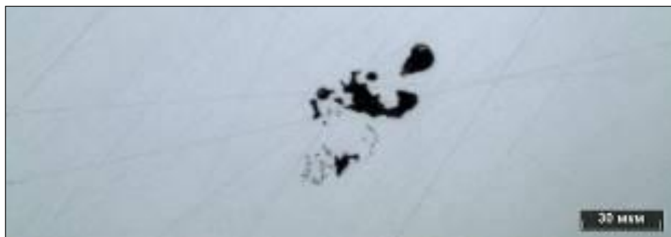
Рисунок 3.90 – Дефект в литом ядре в сварной точке 8.1.1, не травлено
