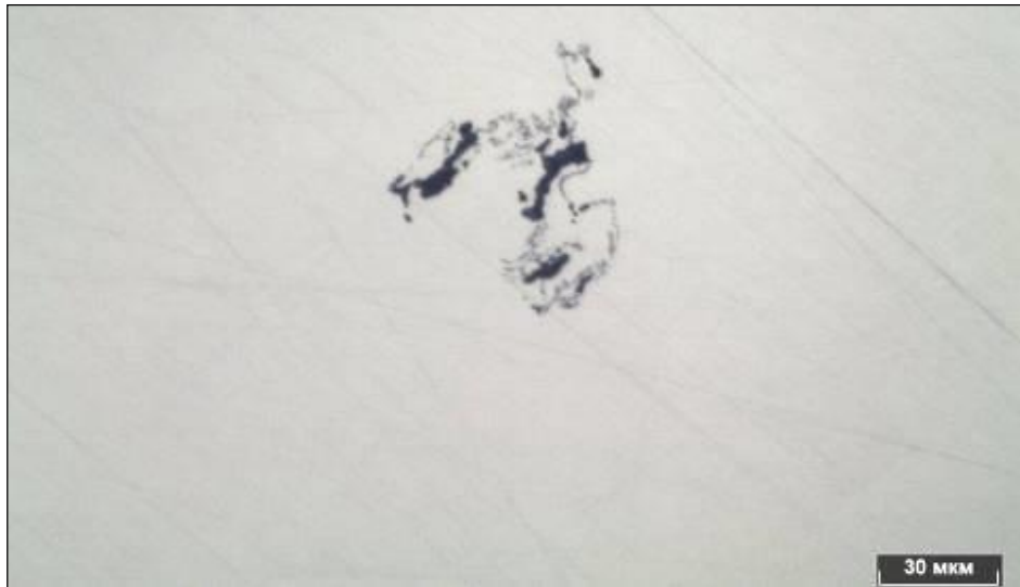
Рисунок 3.46 – Дефект в литом ядре в сварной точке 4.1.1, не травлено
