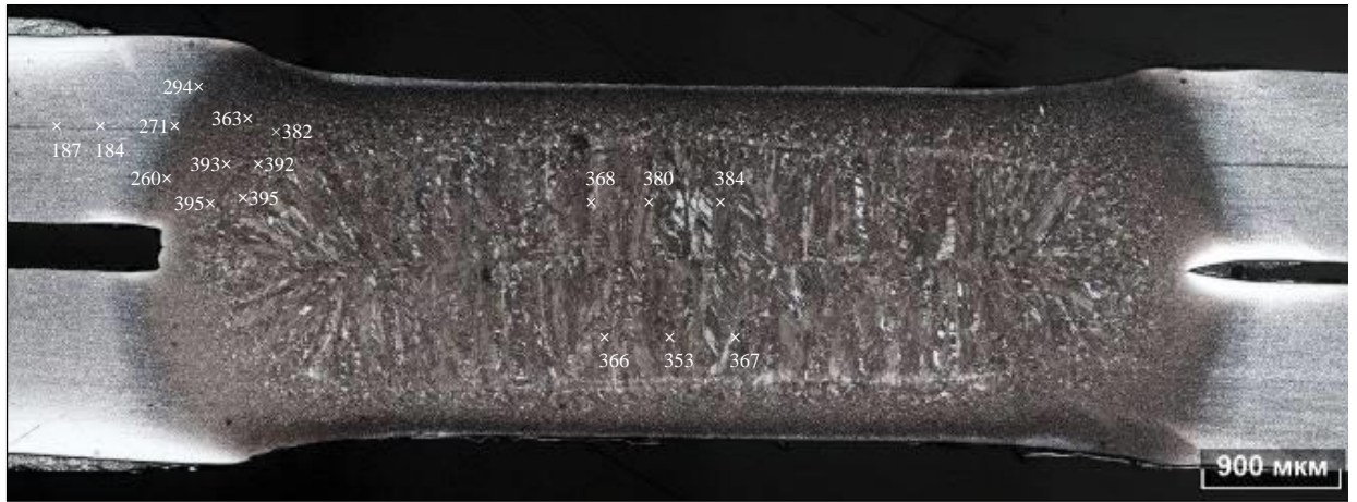
Рисунок 3.118 – Схема замеров твердости HV1 сварной точки 11.1.1
