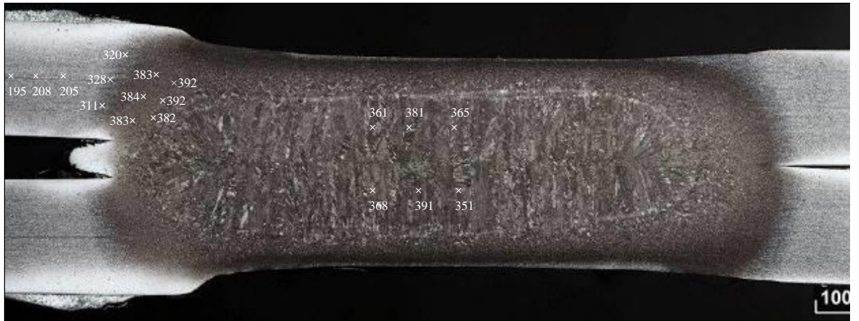
Рисунок 3.97 – Схема замеров твердости HV1 сварной точки 8.1.1
