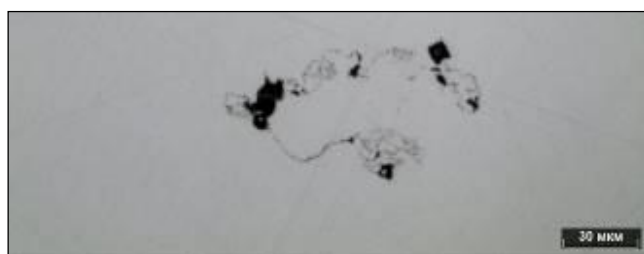
Рисунок 3.116 – Дефект в литом ядре в сварной точке 11.1.2, не травлено
