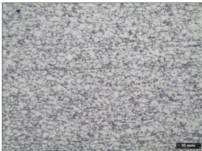
Рисунок 3.67 – Микроструктура проката вне зон сварки, точка 6.1.1, травитель – нитал
