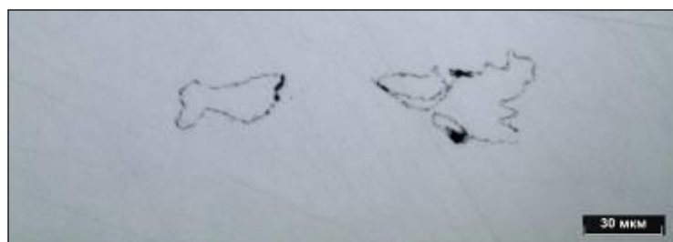
Рисунок 3.117 – Дефект в литом ядре в сварной точке 11.1.3, не травлено
