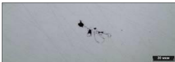
Рисунок 3.101 – Дефект в литом ядре в сварной точке 9.1.1, не травлено
