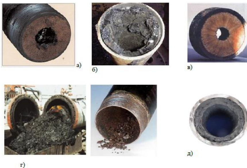
а) парафиносмолистые отложения, б) асфальтосмолистые отложения, в) отложения парафинов, г) парафино-минеральные отложения, д) коксоотложения
