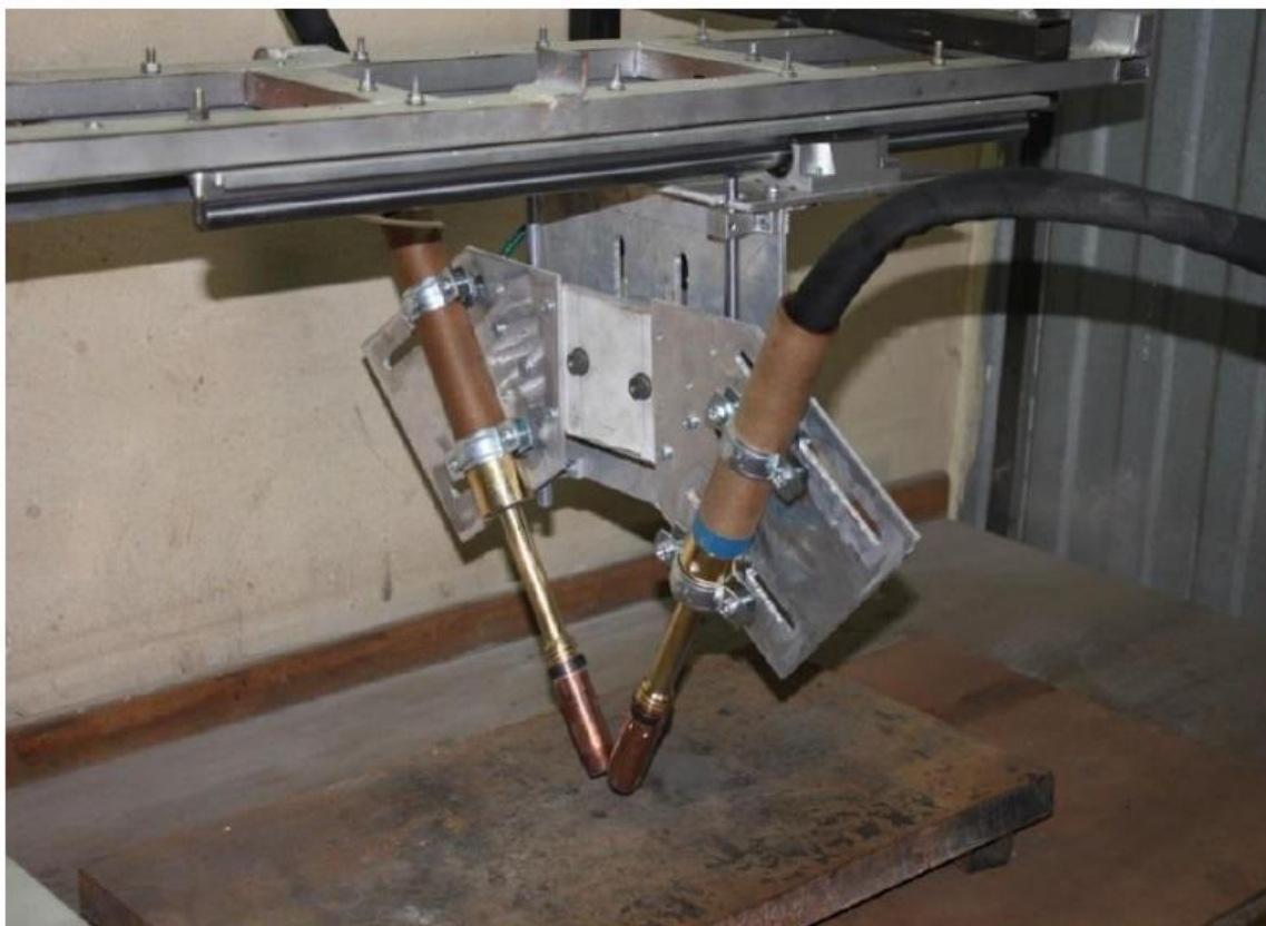
Рисунок 17 – Установка для двухдуговой наплавки [2]
