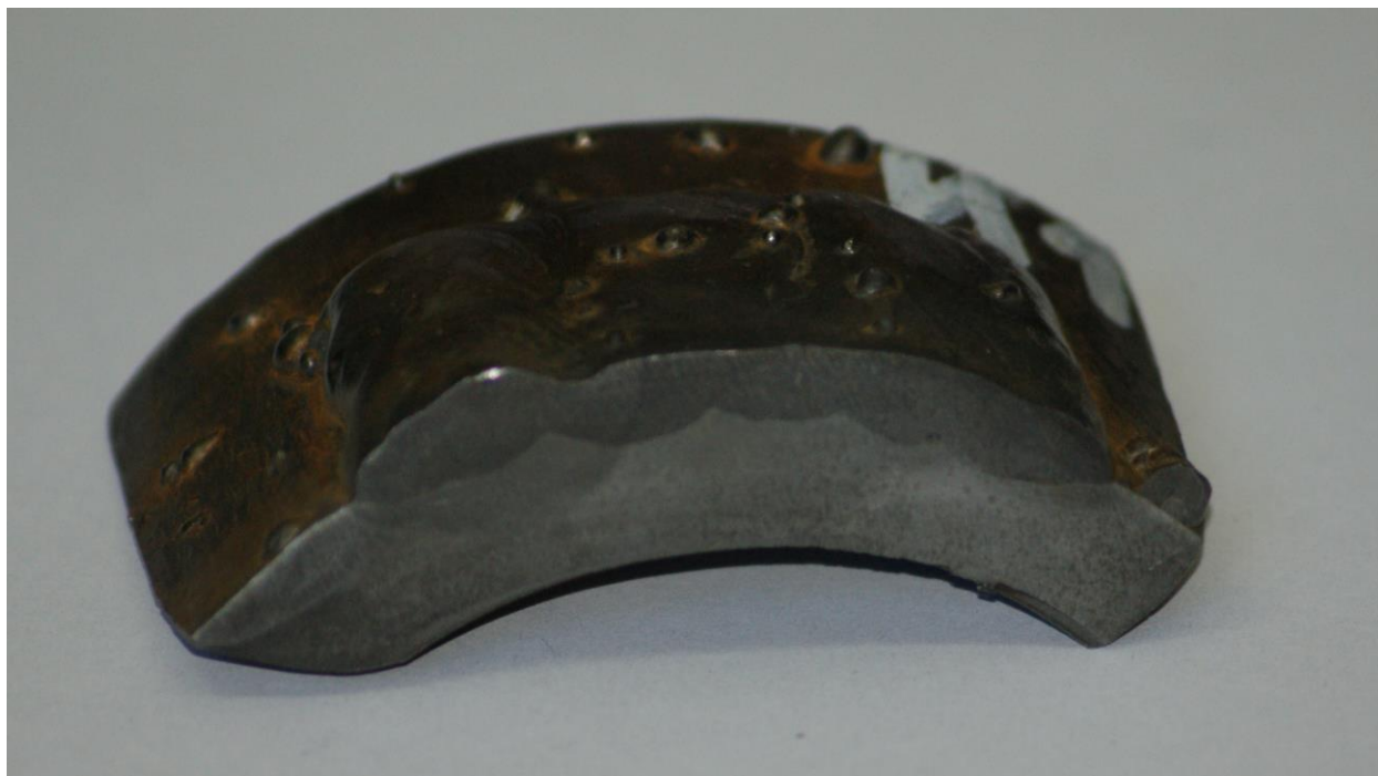
Рисунок 29 – Сектор муфты с наплавленным слоем (И-1)
