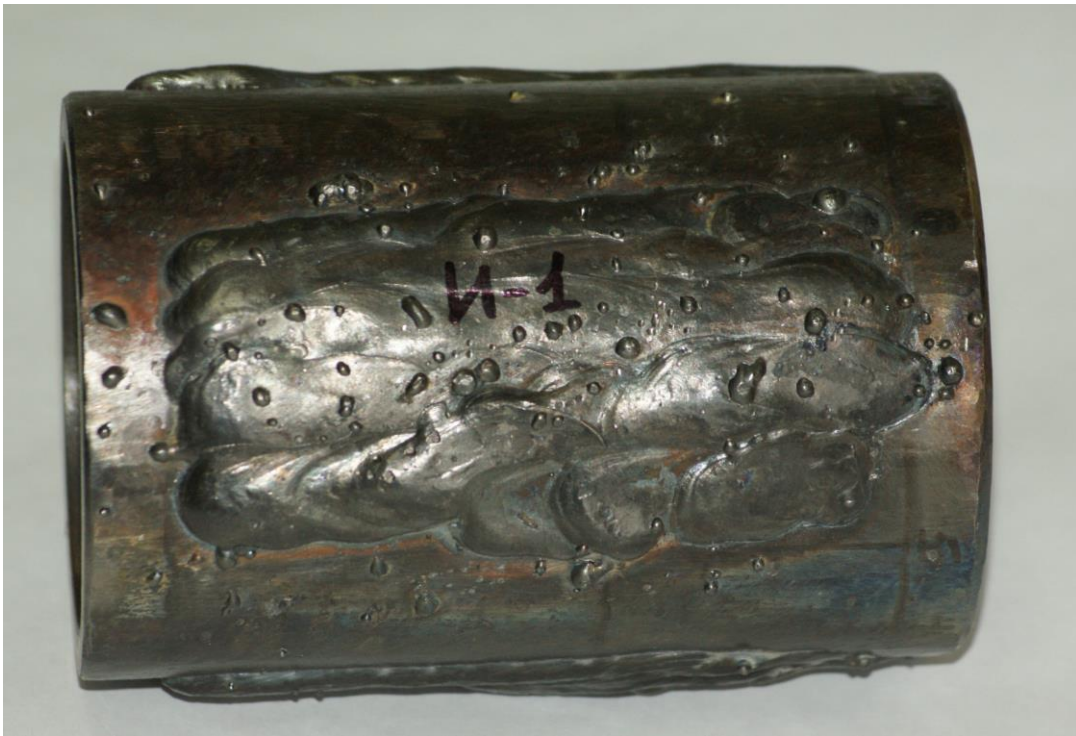
Рисунок 26 – Наплавленная муфта, слой выполнен проволокой Нп-08Г2С (И-1)
