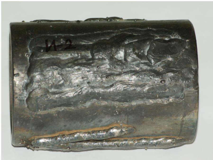
Рисунок 27 – Наплавленная муфта, слой выполнен проволокой Нп-30ХГСА (И-2)
