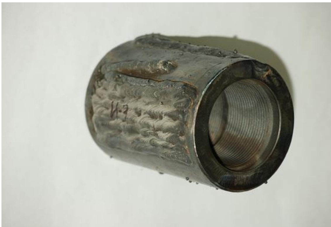
Рисунок 28 – Наплавленная муфта, комбинированный слой (И-3)
