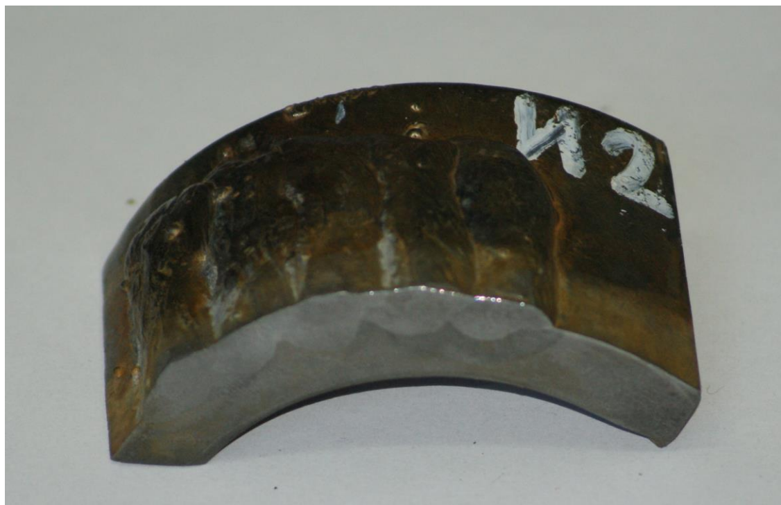
Рисунок 30 – Сектор муфты с наплавленным слоем (И-2)
