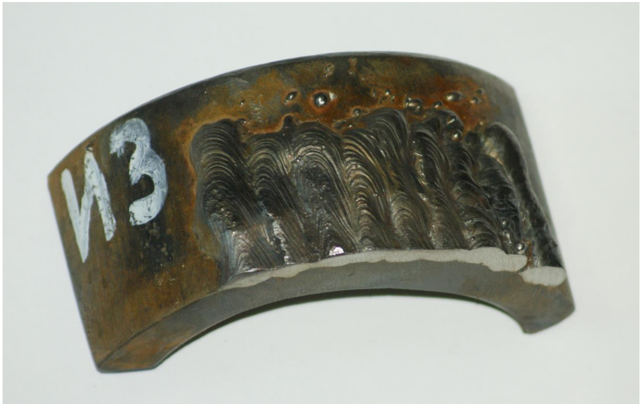
Рисунок 31 – Сектор муфты с наплавленным слоем (ИЗ)
