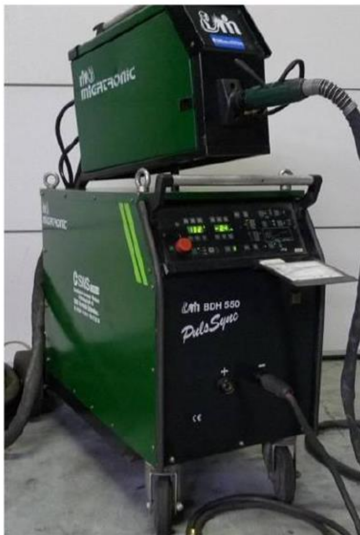
Рисунок 18 – Сварочный полуавтомат Megatron BDH 550
