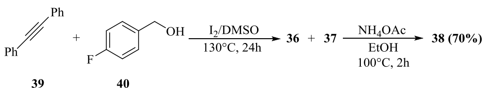
Схема 8 – Синтез 2,4,5-тризамещенного имидазола 38 с использованием окисляющей системы I 2 -DMSO
