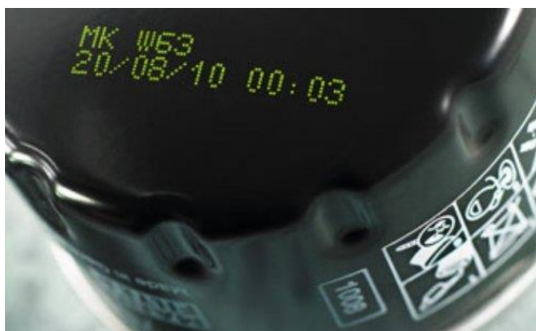
Рисунок 4 – Пример каплеструйной маркировки
