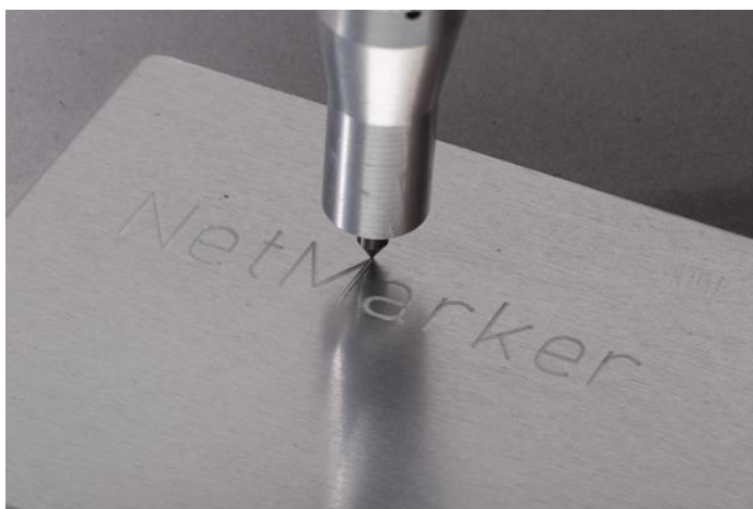
Рисунок 5 – Метод ударно-точечной маркировки
