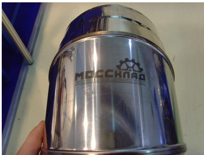
Рисунок 10 – Пример электрохимической маркировки
