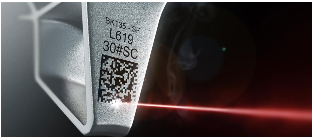
Рисунок 3 – Пример процесса нанесения лазерной маркировки
