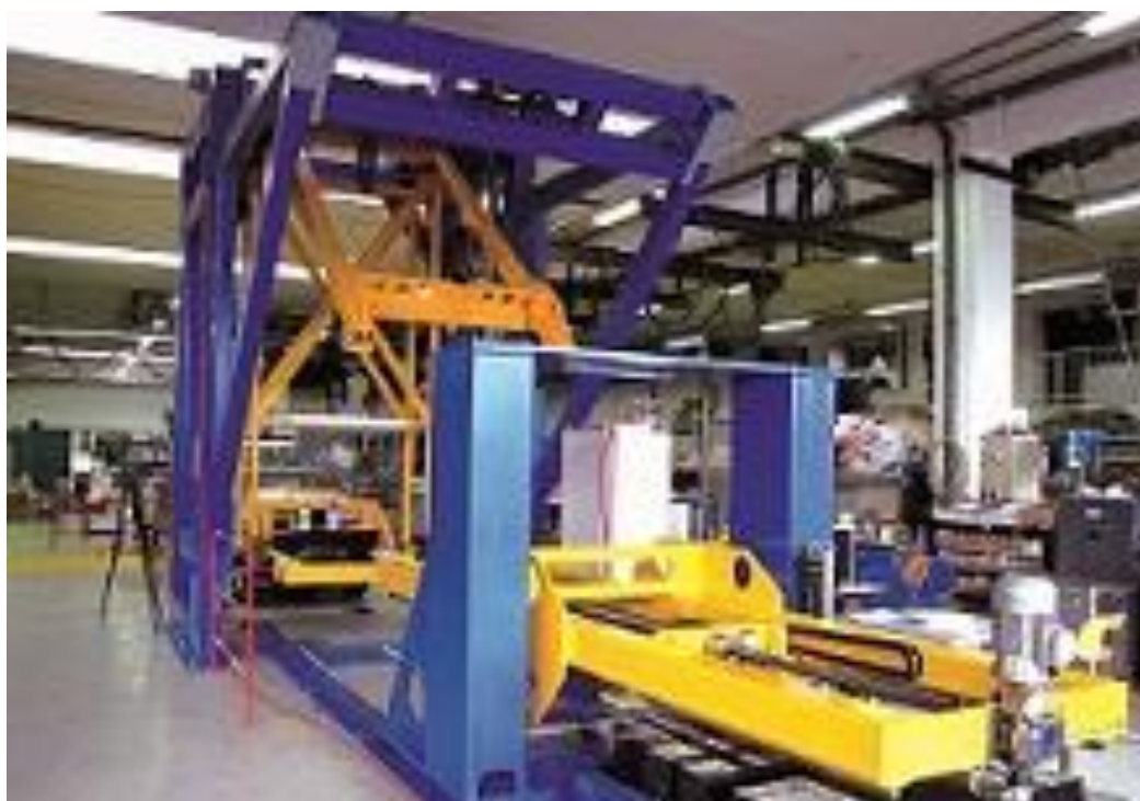
Рисунок 5 - Общий вид прецизионного маятникового тарана
