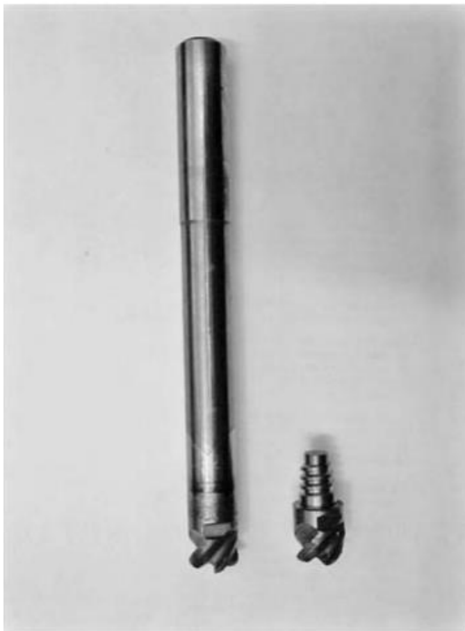
Рисунок 3 – Конструкция сборной твердосплавной концевой фрезы производства фирмы Sandik Coromant со сменной рабочей частью
