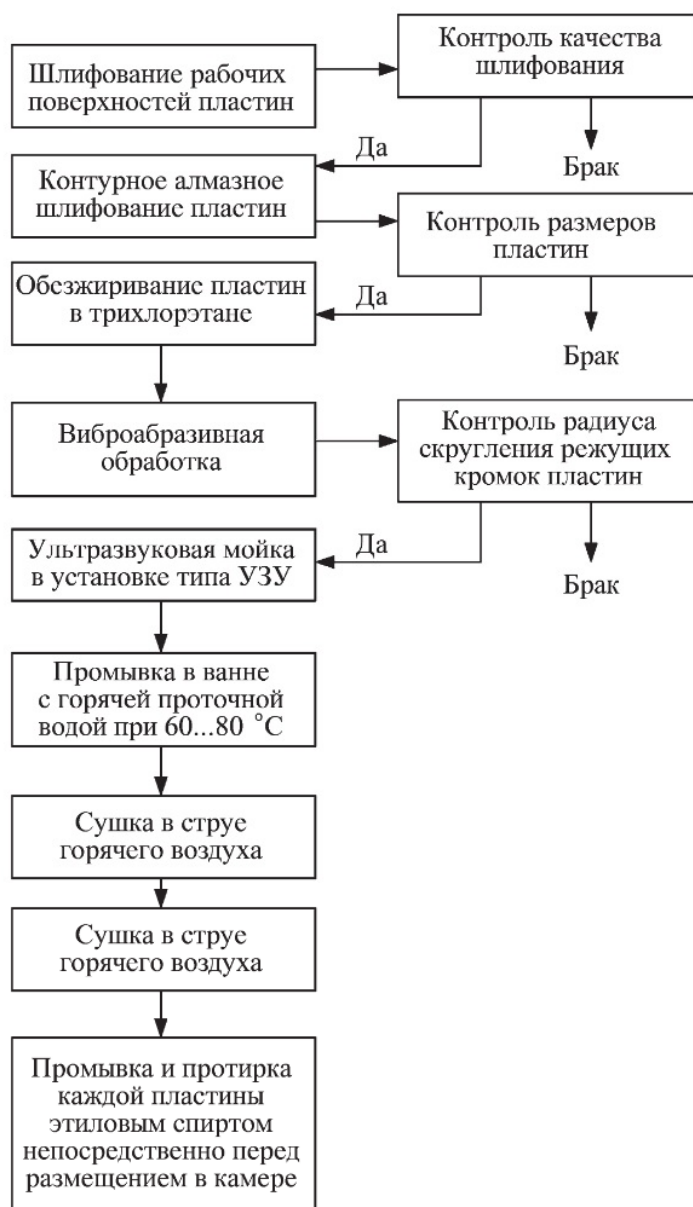
Рисунок 27 - Типовой процесс подготовки поверхностей пластин из твердого сплава к нанесению покрытий
