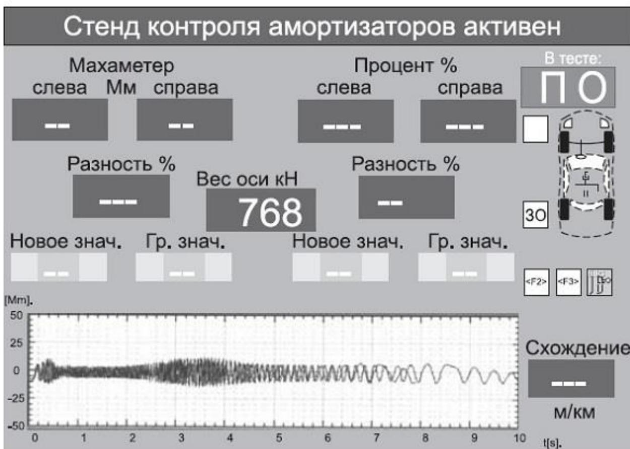
Рисунок 5 – Данные контроля амортизаторов
