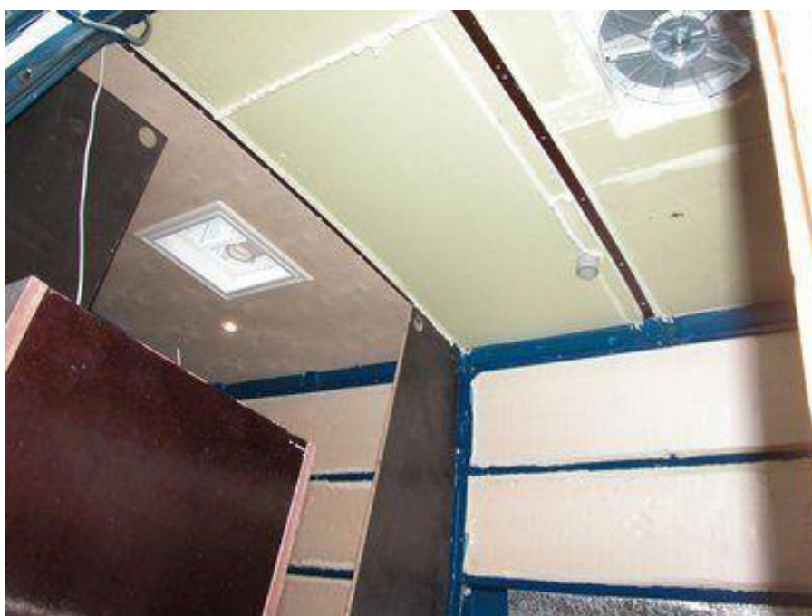
Рисунок 36 – Отделка кузова термо- и виброзащитными материалами
