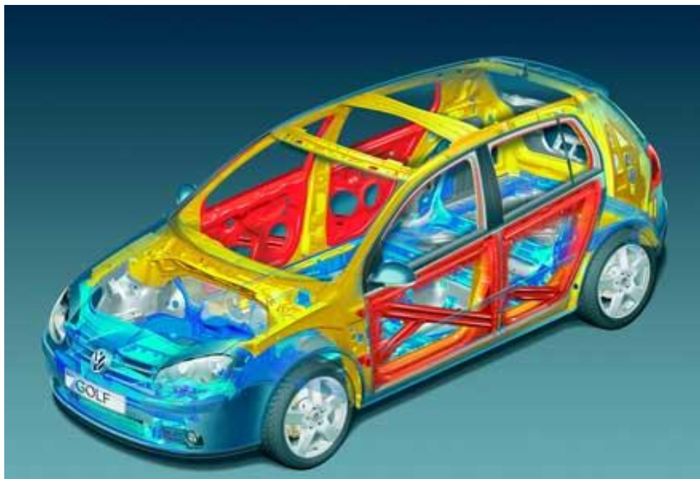
Рисунок 40 - Элементы программируемой деформации кузова
