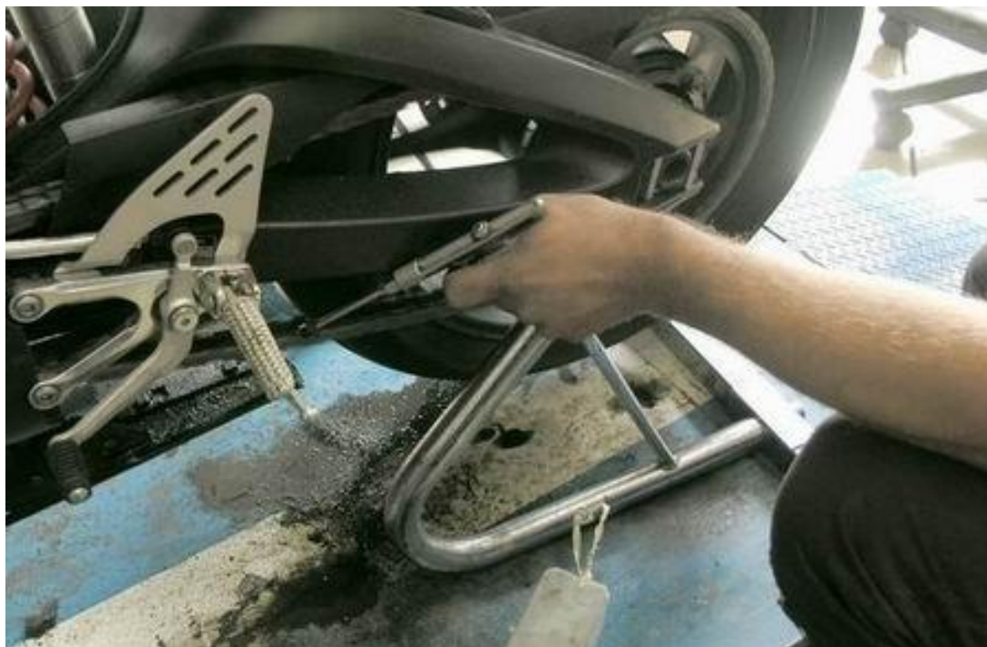
Рисунок 14 – Очистка цепи сжатым воздухом
