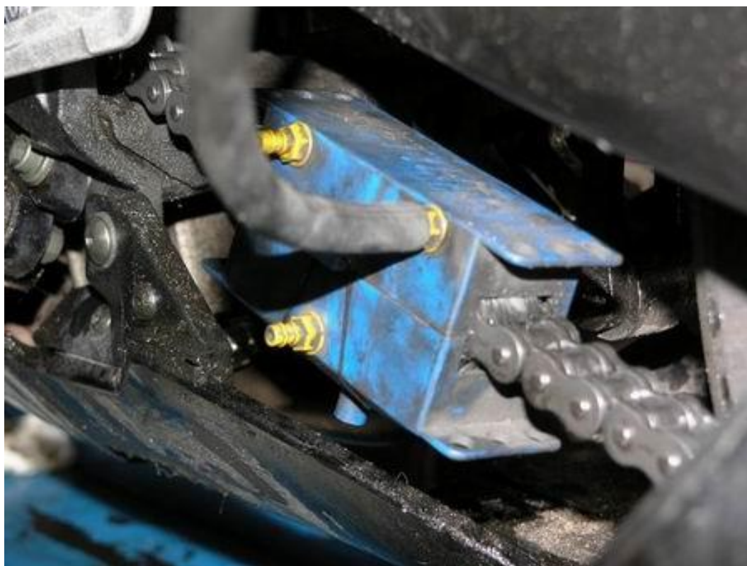
Рисунок 13 – Машинка для чистки цепи, закрепленная на мотоцикле
