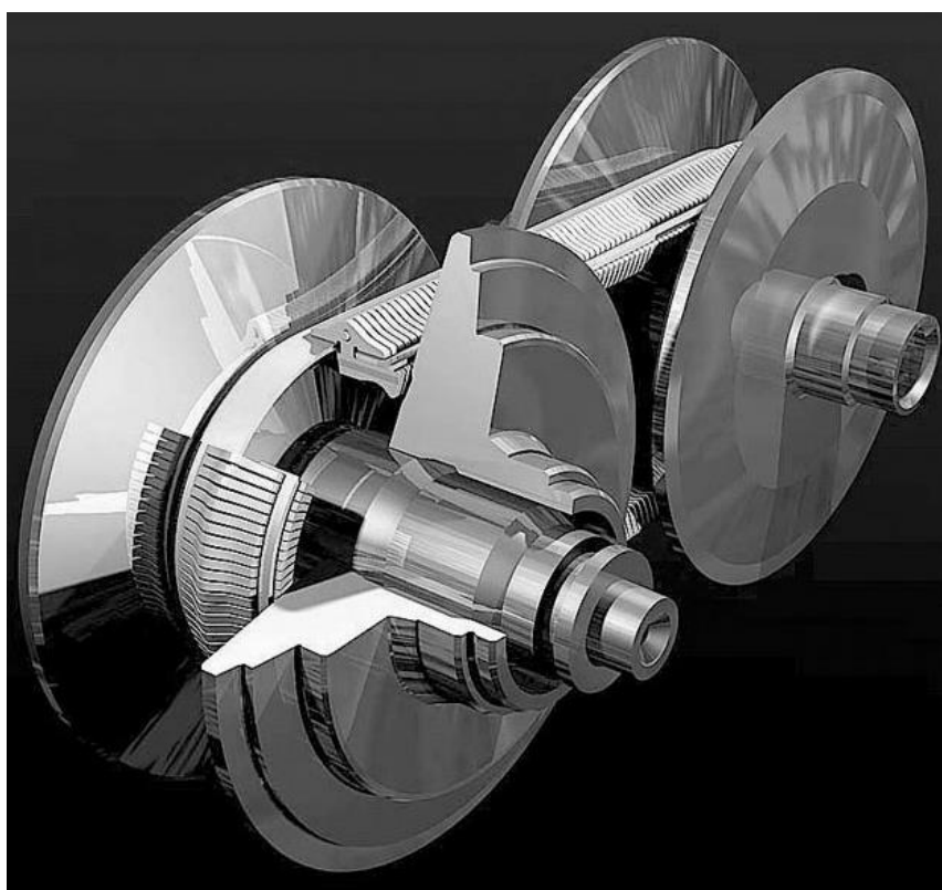
Рисунок 2 – Принципиальная конструкция клиноременного вариатора
