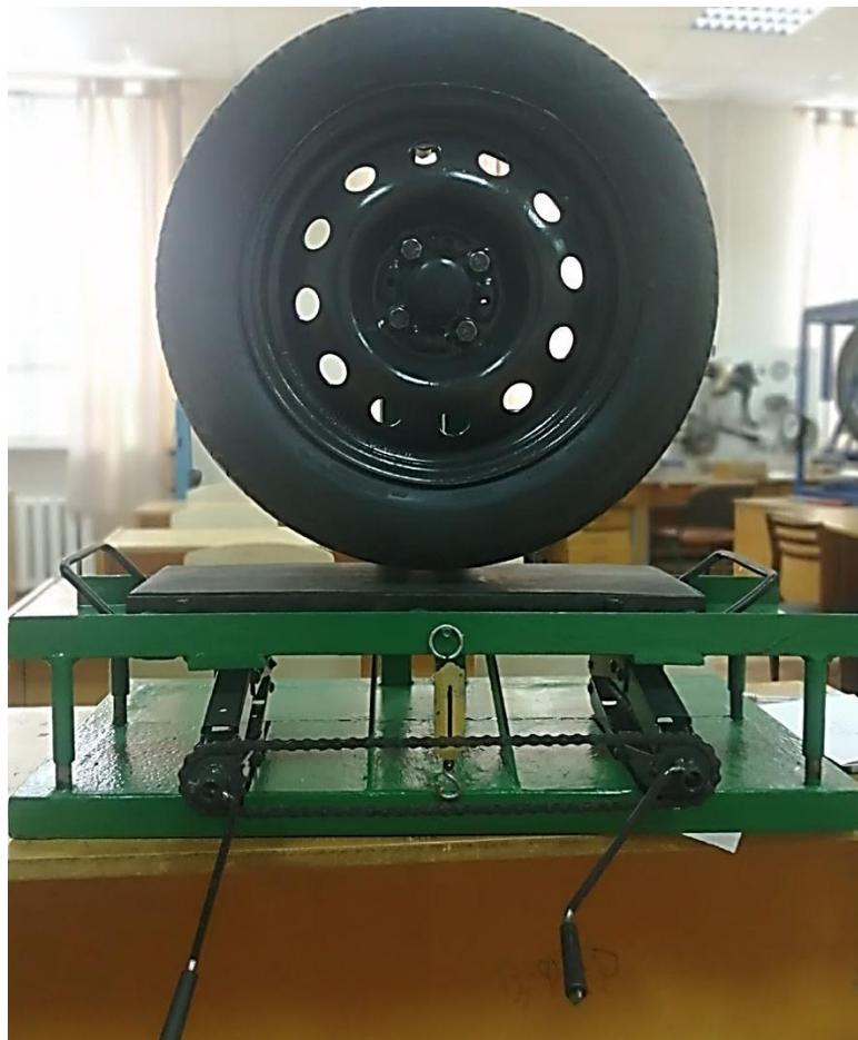
Рисунок 16 – Лабораторная установка для определения углов увода колеса. Вид главный.
