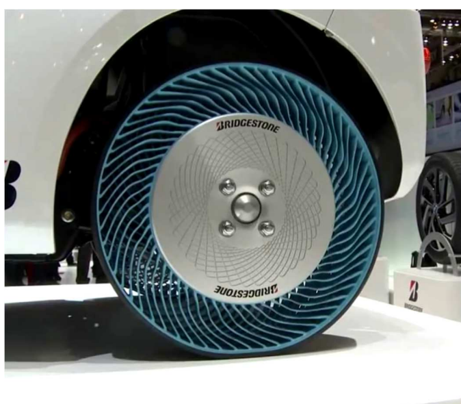
Рисунок 9 – Безвоздушное каркасное колесо компании Bridgestone
