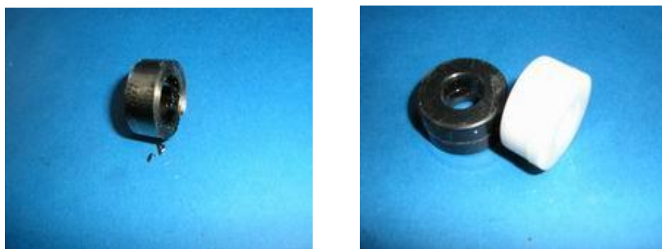
Рисунок 1.8 – Внешний вид трансформаторного датчика тока.
