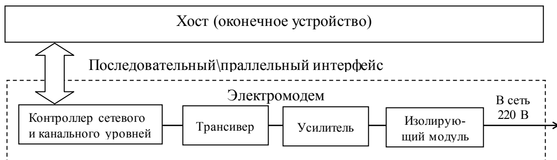
Рисунок 1.14 - Блок-схема коммуникационного узла.
