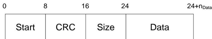
Рисунок 2.20 – Формат пакета передачи от ПК к прибору ИУШ.
