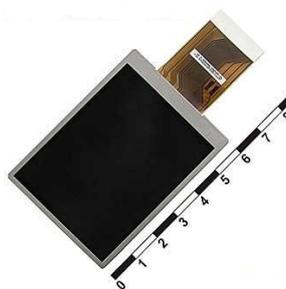
Рисунок 1.14 – TFT дисплей, внешний вид.
