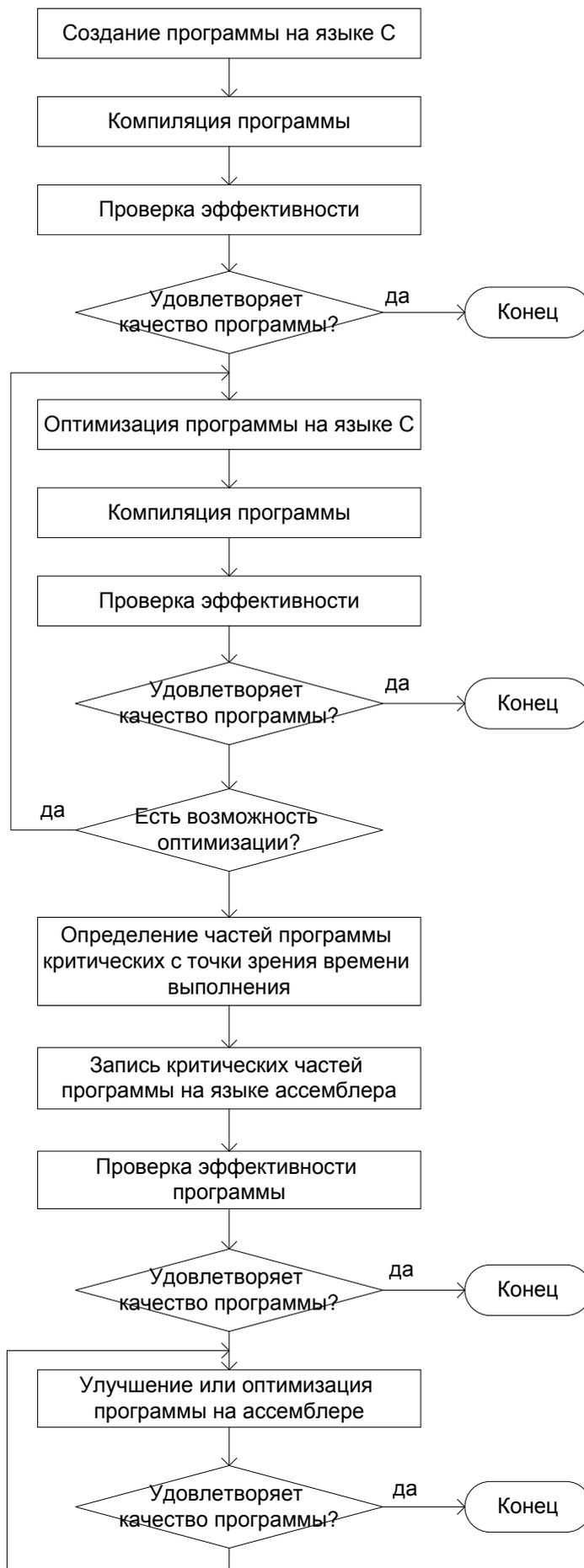
Рисунок 3.6 – Путь построения выполняемой программы.
