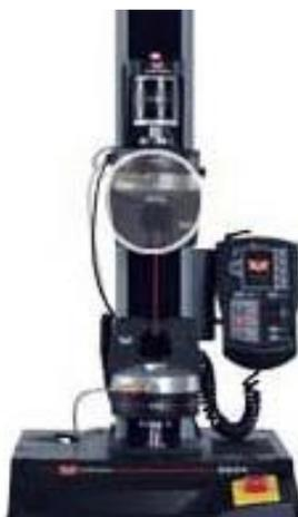
Рисунок 2.14 – Установка измерения прецизионных пружин.
