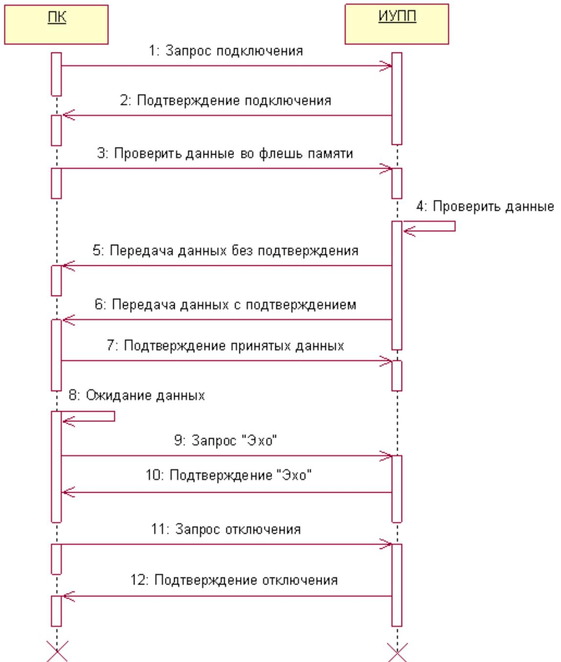
Рисунок 2.18 – Схема взаимодействия ПК с МПС ИУПП.
