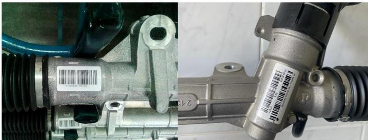
Рисунок 17 – Идентификация рулевого механизма
