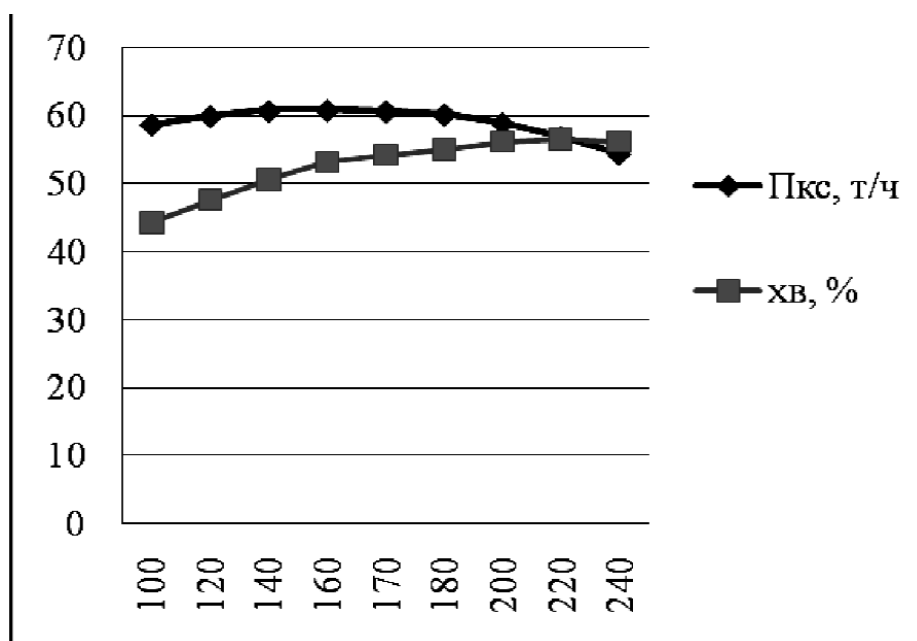
Рисунок 2.2 - График зависимости производительности колонны и степени превращения от температуры
