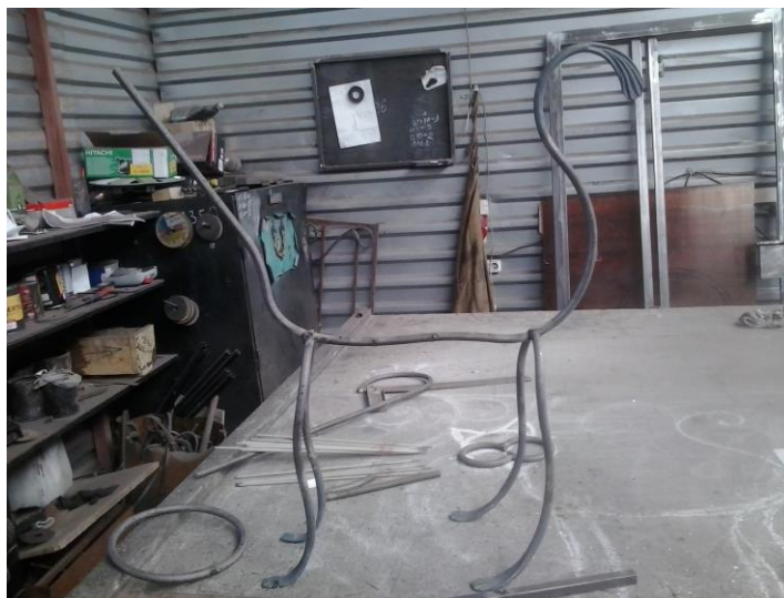
Рисунок 34 – Сборка и сварка деталей изделия
