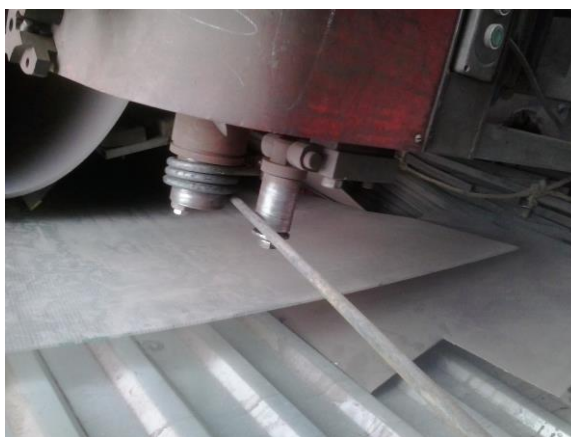
Рисунок 31 – Гибка деталей подставки под цветы
