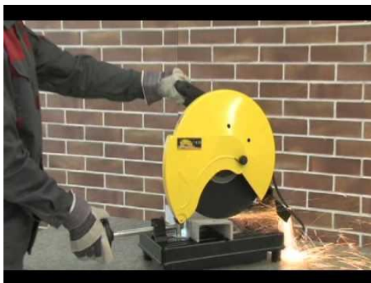
Рисунок 30 – Резка деталей изделия
