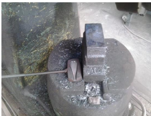
Рисунок 32 – Штамп для изготовления «лапок» изделия
