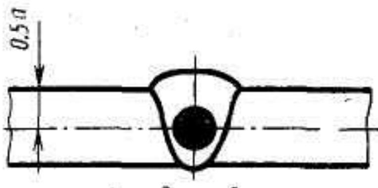
Рисунок 12 - Место вырезки образца
