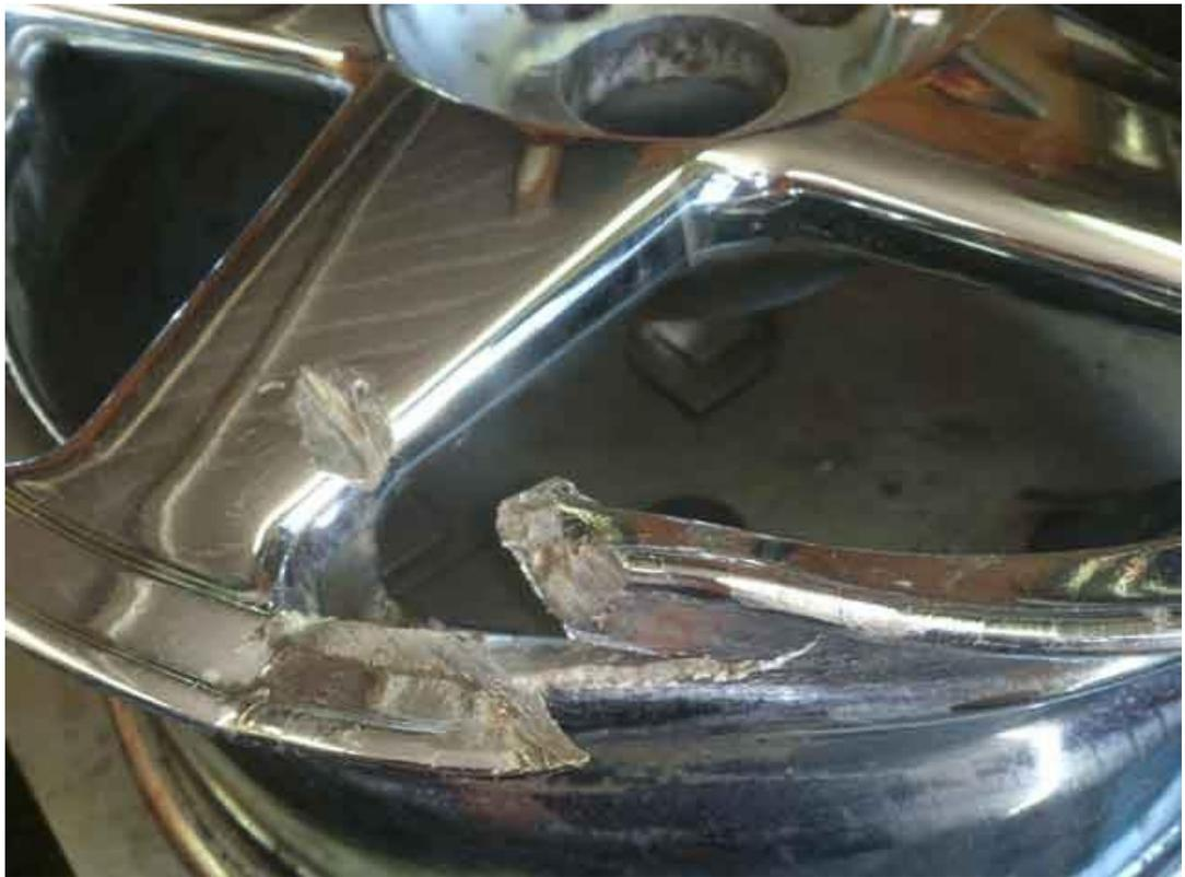
Рисунок 8 – Разрыв диска
