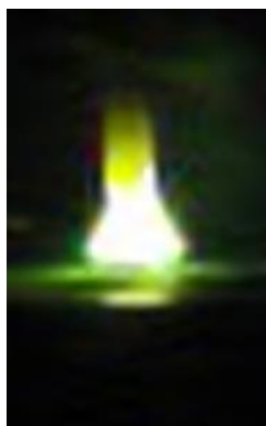
Рисунок 18 – Горение дуги прямой полярности
