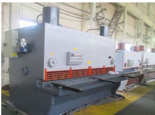
Рисунок 6 – Ножницы гильотинные с гидравлическим приводом НГ-32Г/02
