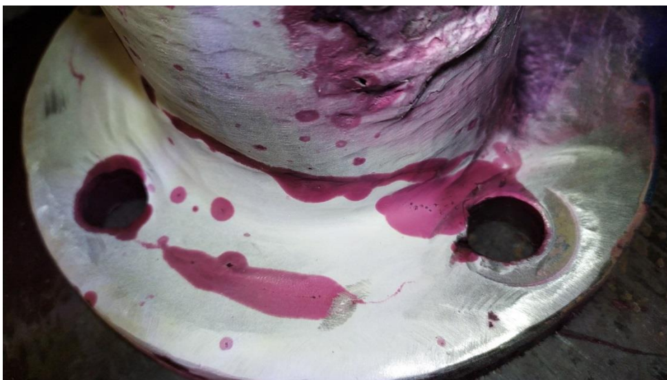
Рисунок 6 – Результат капиллярного метода контроля сварных швов
