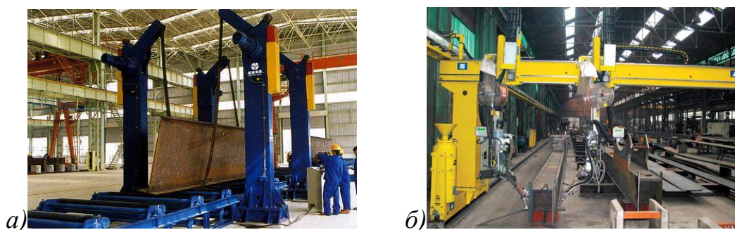
Рисунок 12 – Автоматическая сварка под флюсом поясов: цепной кантователь (а) и сварочный портал (б)
