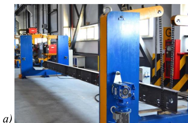
Рисунок 14 – Оборудование для автоматической сварки под флюсом стоек и раскосов: цепной кантователь (а), сварочный трактор Tripletrac A2TF (б)
