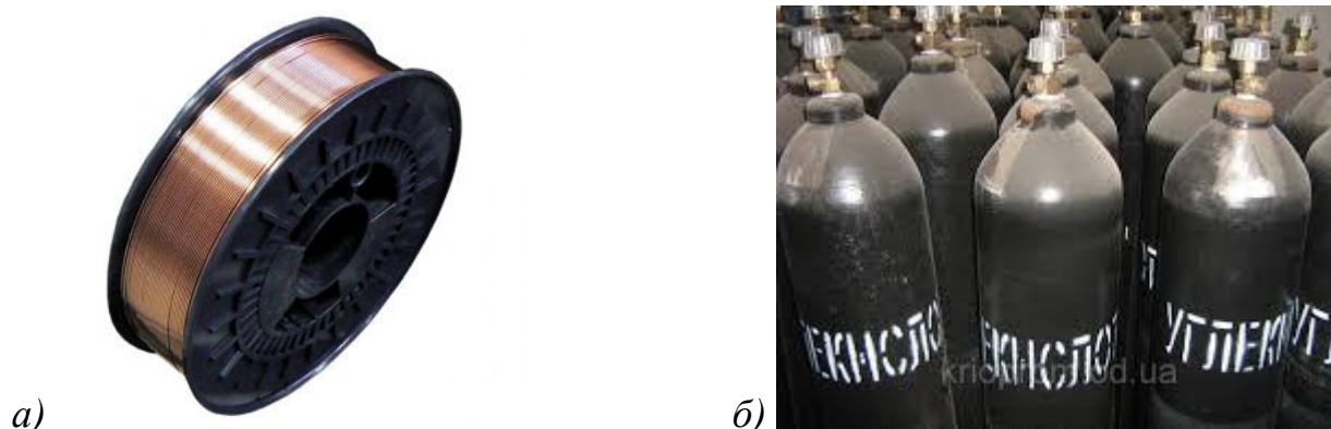
Рисунок 16 – Сварочные материалы: проволока Св-08ГС (а) и баллоны с углекислым газом (б)
