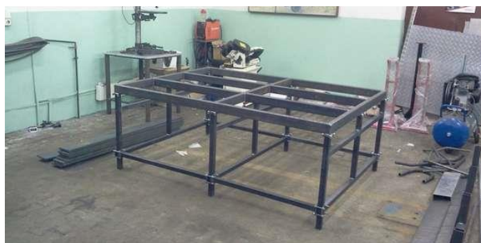
Рисунок 7 – Стенд для сборки и сварки
