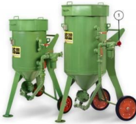
Рисунок 3 – Переносная пескоструйная установка DBS-100 и DBS-200
