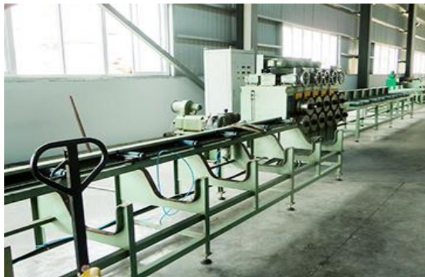
Рисунок 4 – Правка сортового проката на машине JZJ20-40
