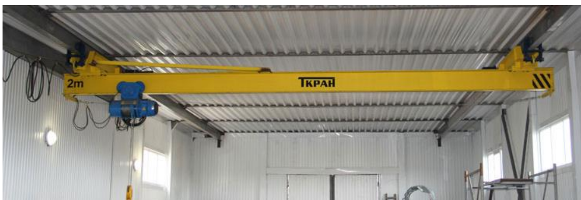
Рисунок 6 – Крюковый однобалочный кран грузоподъёмностью 2 т
