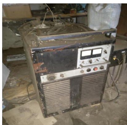
Рисунок 8 – Сварочный выпрямитель ВДУ-506
