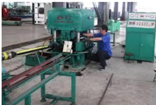
Рисунок 18 – Правка сортового проката на машине JZJ 20-40
