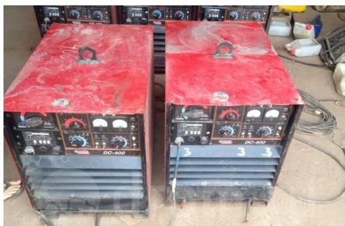
Рисунок 6 – Оборудование для ручной дуговой сварки: источник питания DC-400
