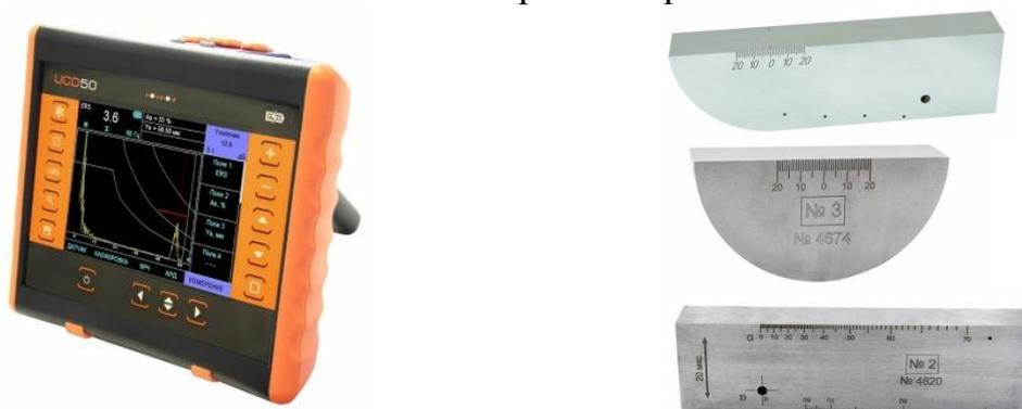
Рисунок 8 – Ультразвуковой дефектоскоп USD-500
