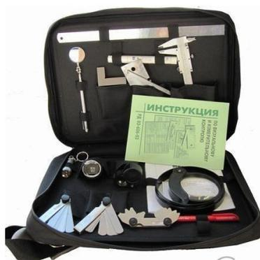
Рисунок 7 – Оборудование для проведения визуально-измерительного контроля сварных швов
