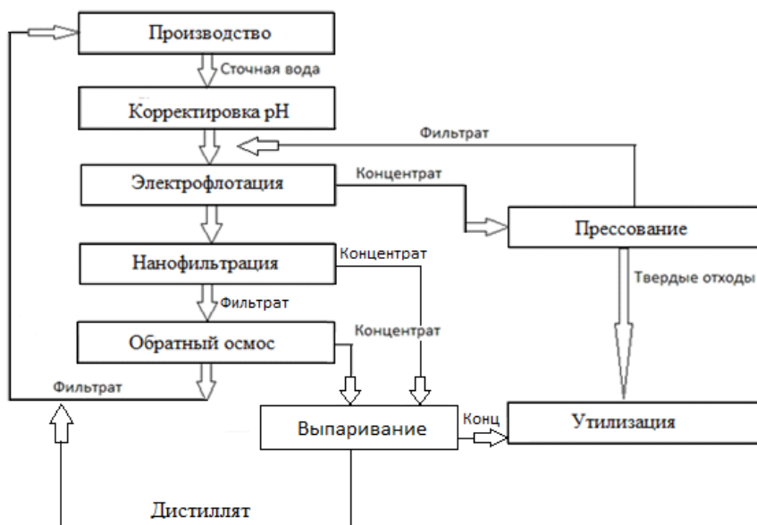
Рисунок 12 – Блок-схема технологии очистки сточных вод металлургического производства
