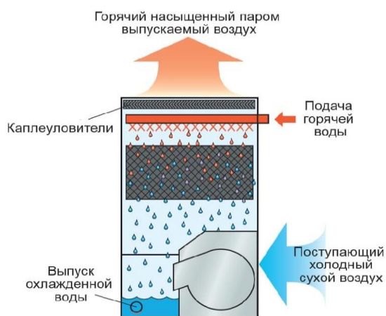
Рисунок 20 – Противоточная градирня
